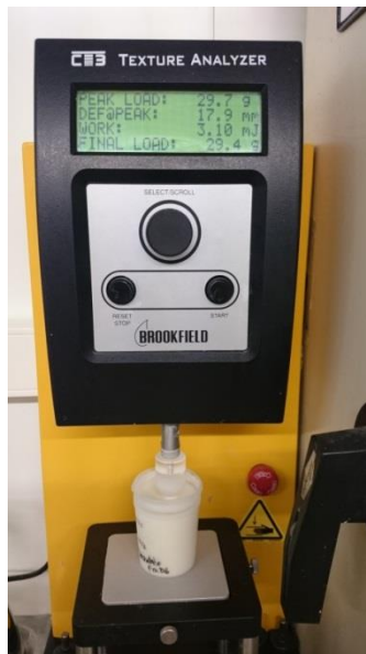
Figura 3. Imagen de la prueba de penetración
