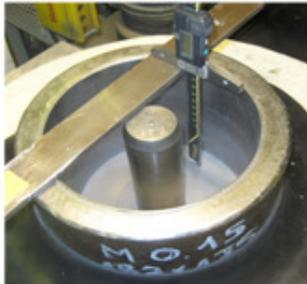
**NOTA:** MEDIR LA PROFUNDIDAD EN CADA CAMBIO DE EQUIPO EN LOS 4 PUNTOS MARCADOS EN LA IMAGEN
