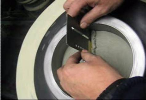
**PASO 3:** Se sigue raseando hasta que la mezcla en la parte inferior de la espátula desaparece porque está uniformemente distribuida.
