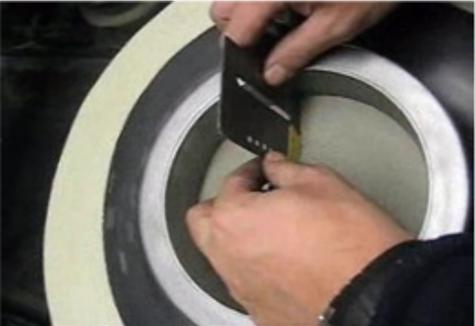
**PASO 4:** El resultado debe ser la mezcla uniformemente distribuida en la superficie del molde, como muestra la imagen.
