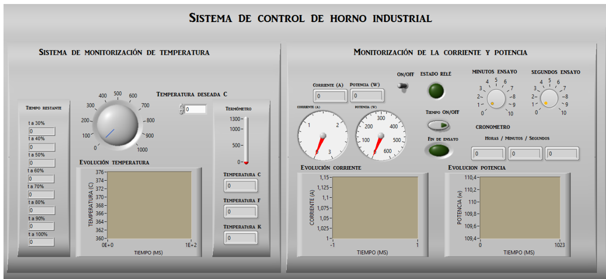
Figura 34: Panel frontal de monitorización del sistema
