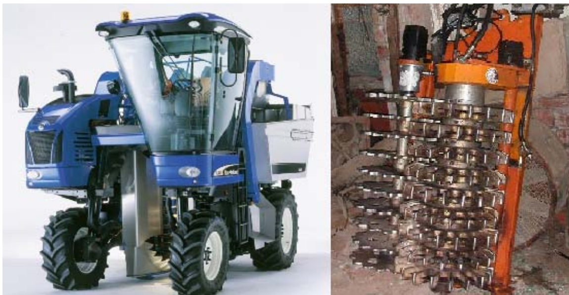
Figura nº 23. Nueva vendimiadora automotriz y prepodadora para espaldera.
