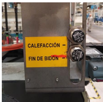
Ilustración 5.8 - Detectores de cambio de bidón VW Navarra
