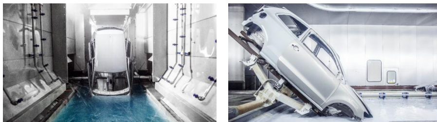
Ilustración 3.18 – Tratamientos de limpieza, fosfatación y cataforesis
