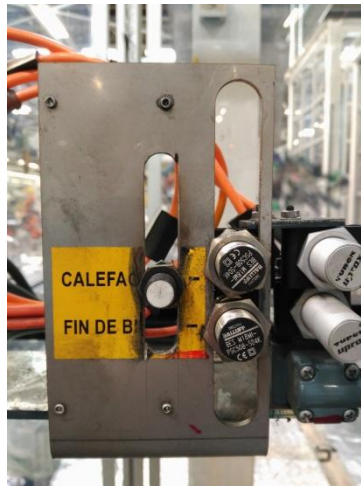
Ilustración 5.9 - Chapa de detección de cambio de bidón fresada
