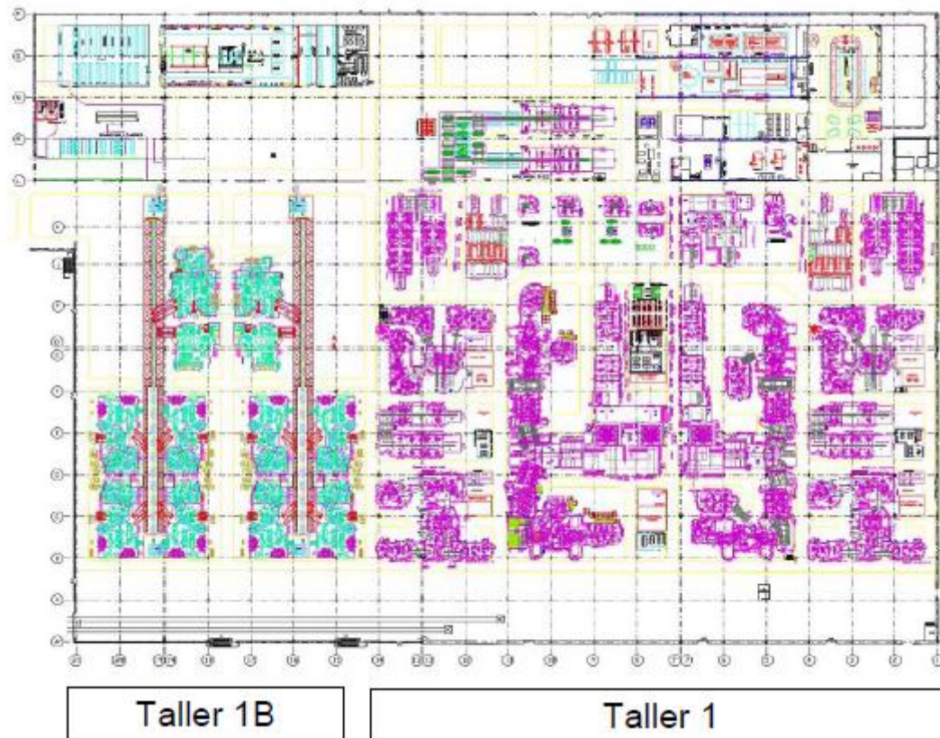
Ilustración 3.22 - Lay out del taller de Chapistería
