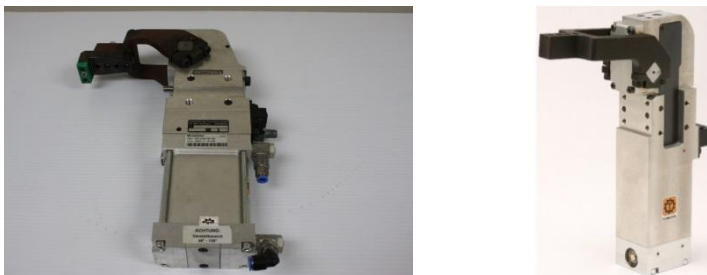
Ilustración 4.6 - Bridas empleadas en el taller de Chapistería
