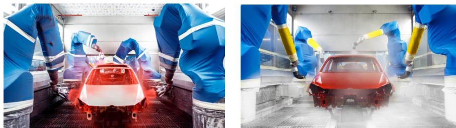
Ilustración 3.19 - Aplicación de base y barniz
