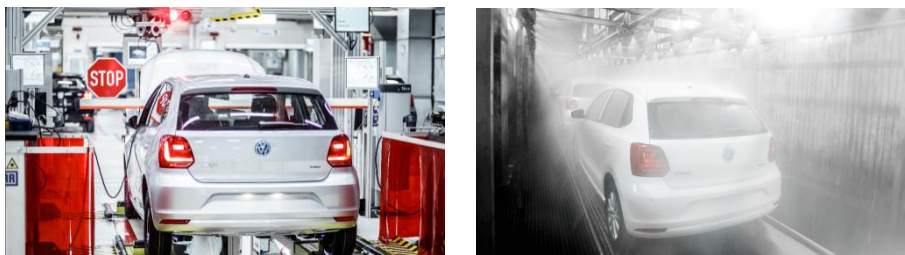
Ilustración 3.21 - Prueba de convergencia y lluvia
