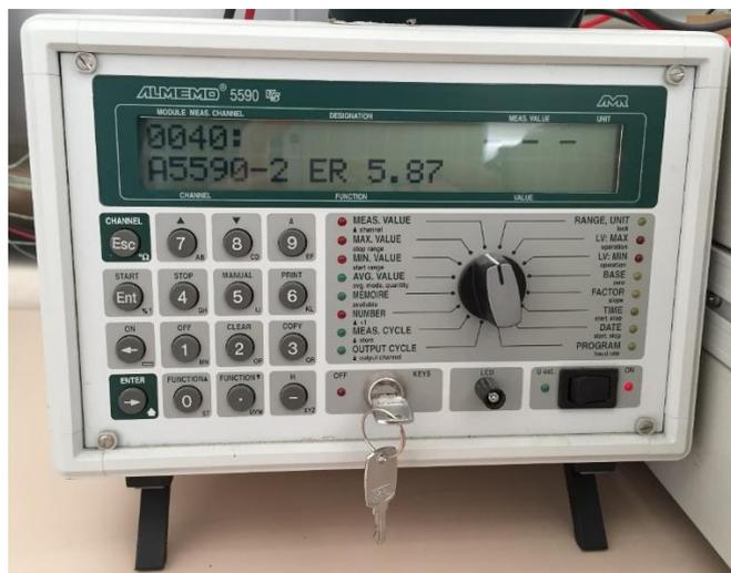
Figura 6.8 Adquisidor de datos ALMEMO 5590.
