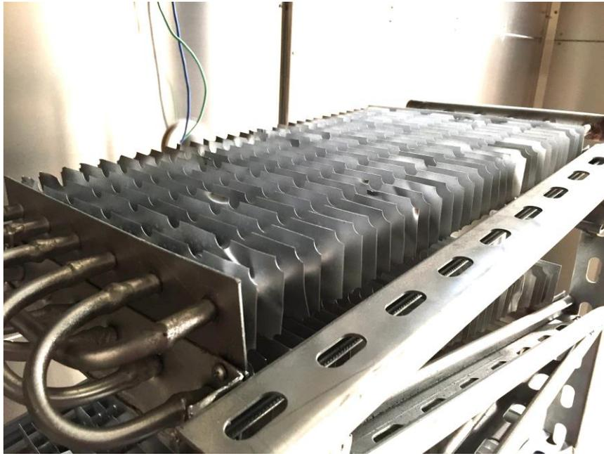
*Figura 6.4 Posición y geometría de las aletas del termosifón.*
