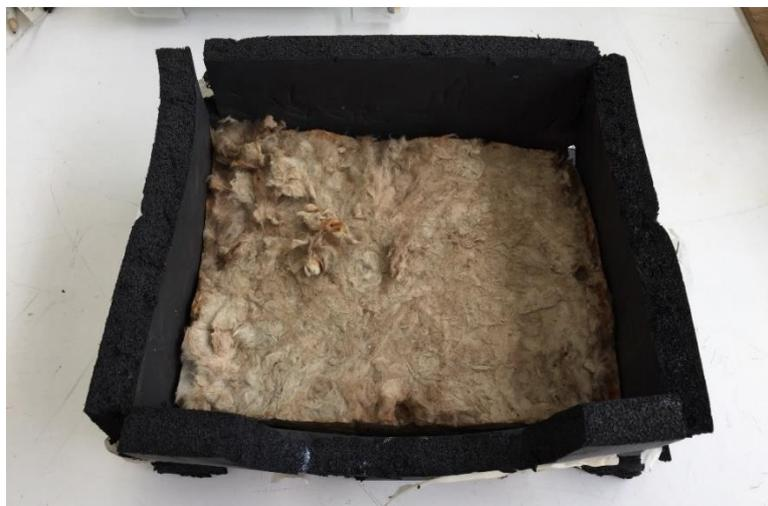
*Figura 6.13 Material aislante utilizado para cubrir el calderín.*
