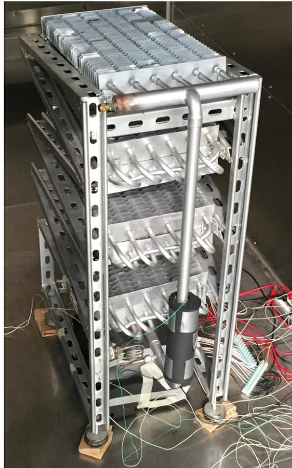
*Figura 6.3 Foto del termosifón mostrando el tubo ascendente y las ramificaciones.*
