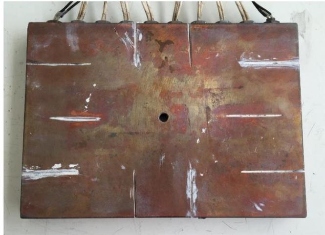
*Figura 6.12 Placa calefactora.*
