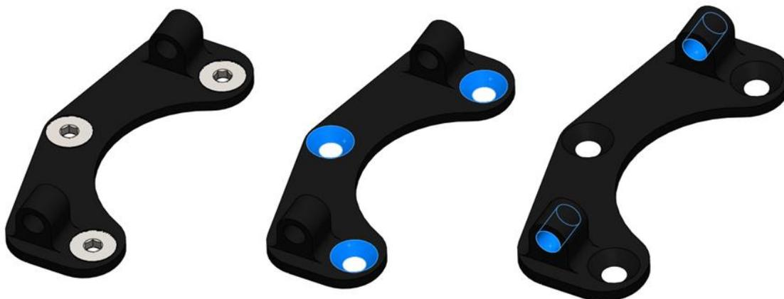
La carga aplicada al progresar sobre la nieve es en los taladros donde se introduce el pasador para establecer el contacto. Se ha estimado una carga de 200 N en dirección vertical y sentido contrario a las sujeciones.
