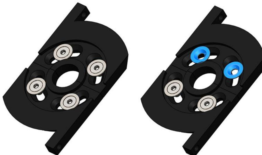
La carga es aplicada por la Fixation link sobre la Base disk, teniendo como punto de contacto entre ambos la cuña de inclinación 60°. Se ha estimado una fuerza muy superior a la ejercida en funcionamiento normal, concretamente 4000 N, que se reparten entre los 4 Base disk que compone el conjunto total, es decir, 1000N sobre cada Base disk.
