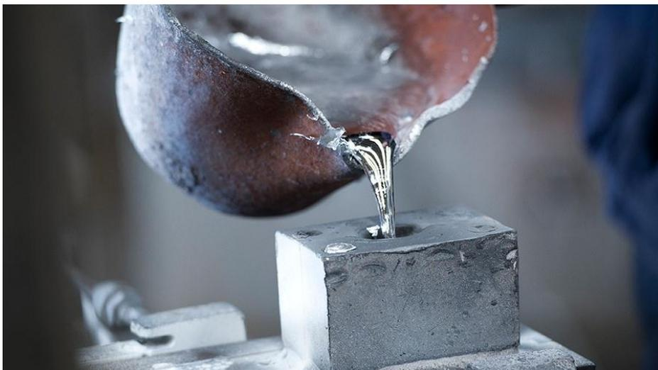
Las piezas resultantes de este proceso de fundición en coquilla cuentan con buenas propiedades mecánicas y metalúrgicas, una gran resistencia y un acabado superficial excepcional, características que reúnen las piezas diseñadas.
