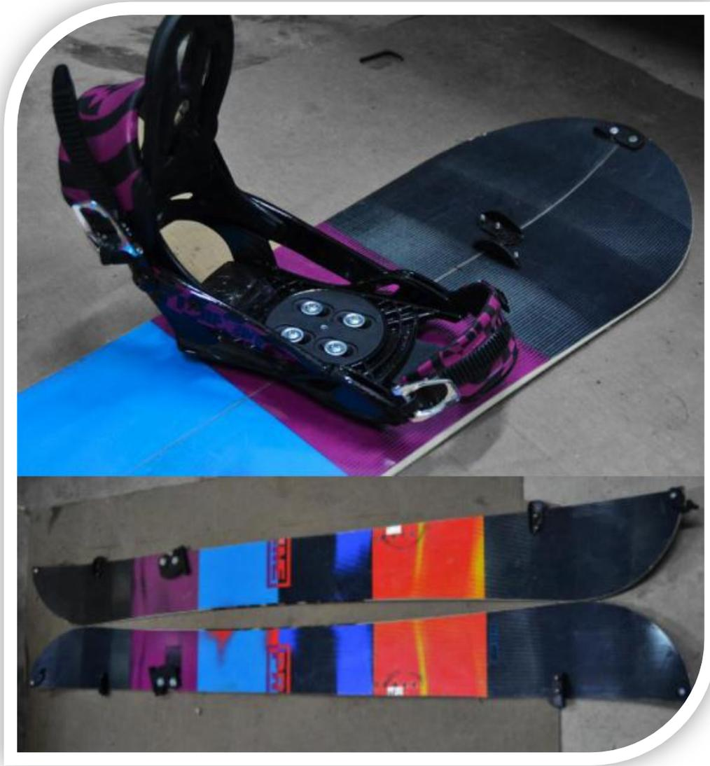
La transformación se ha podido completar en su totalidad debido a que faltan piezas por instalar, como el sistema de ascenso, pero ya se puede observar la correcta y fácil instalación del hardware diseñado.
