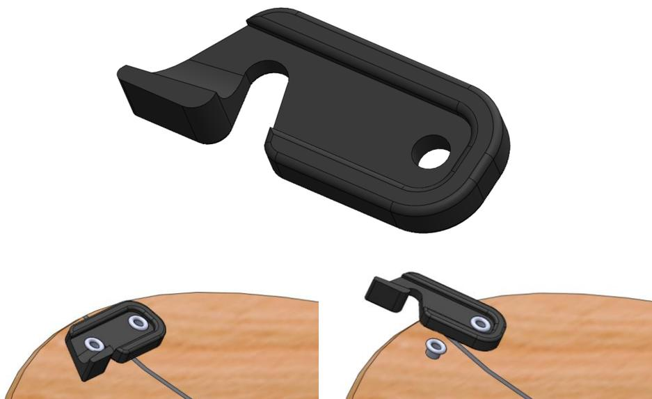
Esta pieza se inserta en los extremos de la tabla y su función es unir las dos mitades. Va anclada a la tabla por medio de dos remaches. Uno de ellos une fijamente el clip a la tabla y el otro es para bloquear la unión. Tiene un pequeño gatillo para moverla. Es de plástico.
