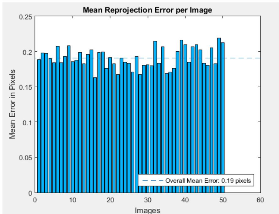
Fig. 31 – Error obtenido en el proceso de calibración de la cámara
