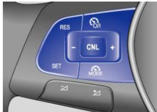
Fig. 52 Lado izquierdo del volante multifunción: teclas para manejar el GRA [1]
