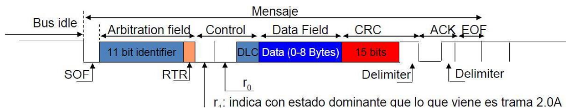
Fig. 4 Trama CAN de datos o remota 2.0A [2]
