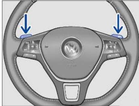
Fig. 56 Volante con dos levas para el Triptronic [1]
