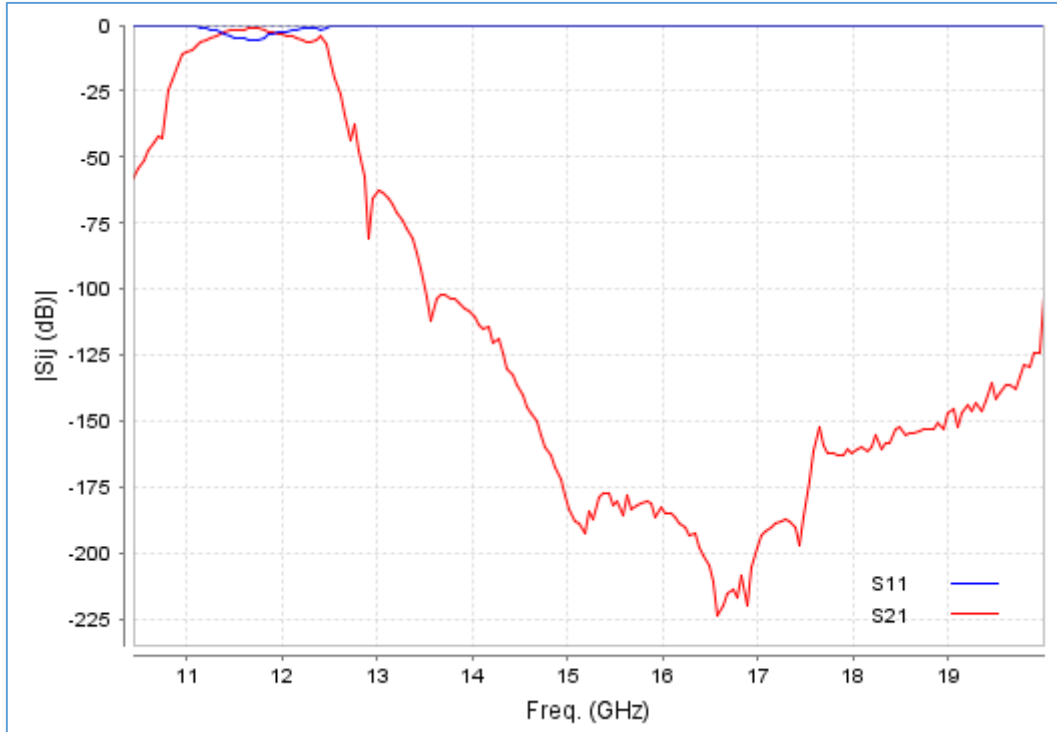
Figura 32. Respuesta del filtro con los singlets. ( FiltroPasoBandaResonadorOpt.FEST3D)
