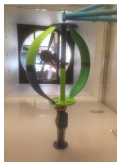
Figuras n°81 y n°82. La torre se instala con la mitad de su cuerpo dentro de la cámara de pruebas atravesando un orificio que luego se sella.
