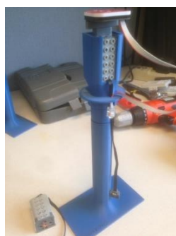
Figuras n°81 y n°82. La torre se instala con la mitad de su cuerpo dentro de la cámara de pruebas atravesando un orificio que luego se sella.
