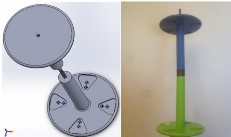
Figura nº104. Base inferior y superior de 4 alojamientos. Diseño CAD y montaje.
