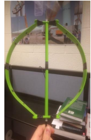
Figura nº110. Turbina con mástil fino sin agujeros y palas de cuerda=3cm.
