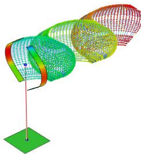
Figura n°48. Simulación computacional del fluido para el modelo con perfil de cuerda=3cm (software QBLADE ).
