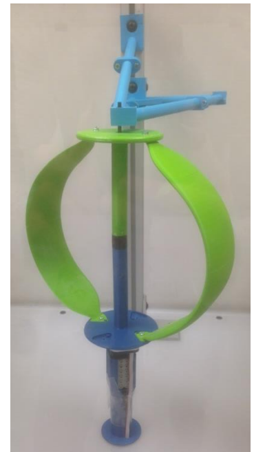
Figura nº108. Turbina bipala. Cuerda del perfil=7cm.
