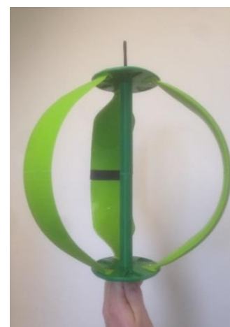
Figura nº112. Turbina tripala. Cuerdas 7,7 y 8cm
