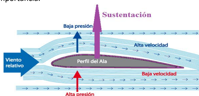
Figura n°18. Presión y velocidad de fluido sobre perfil aerodinámico. Fuente: http://www.pasionporvolar.com
