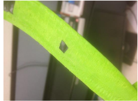
Figura n°65. Superficie lijada (acabado muy malo)
