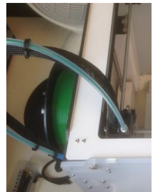
Figura n°61. Bobina de PLA en la parte trasera de la impresora.
