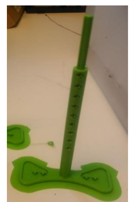
Figura n°75. Base inferior del prototipo2 con agujeros en el mástil
