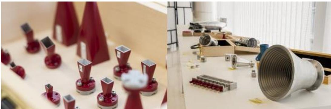
Figura 3.8 – Ejemplos antenas de bocina en guía circular y rectangular
