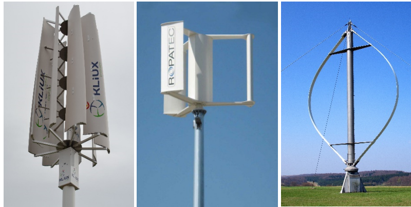
Figura 18. Generadores de eje vertical.
