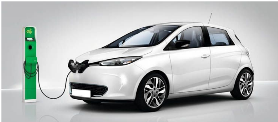
Figura 33. Recarga semirápida con conector Mennekes.
