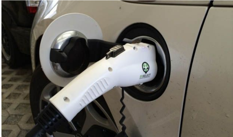
Figura 31. Recarga estándar lenta con conector Tipo 1 (SAE J1772).
