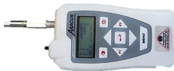
Figura 47: Medidor de partículas
