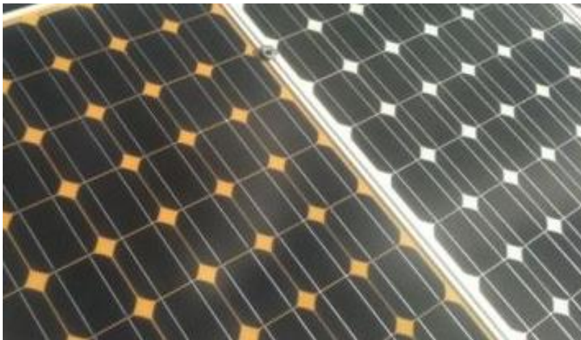
Figura 16: Comparación de un módulo con decoloración y otro en buen estado [16]
