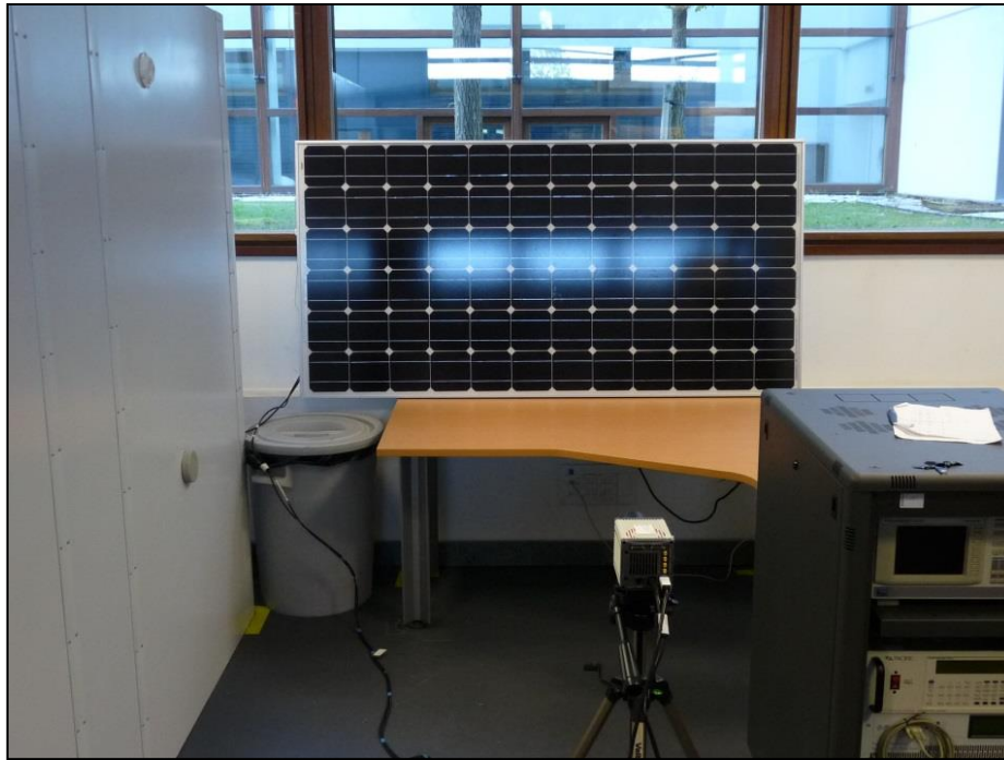
Figura 83: Configuración de módulo y cámara para la realización de los ensayos 1 y 2
