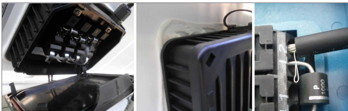
Figura 17: Ejemplo de una caja de conexión abierta (izquierda), mal sellada (centro) y de un cortocircuito causado por un hilo de cable suelto (derecha) [8]
