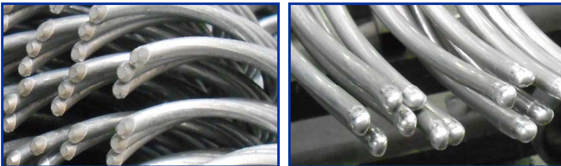
Figura 20. Acabado de puntas de varillas: punta lijada (izquierda) y punta pico loro (derecha).
