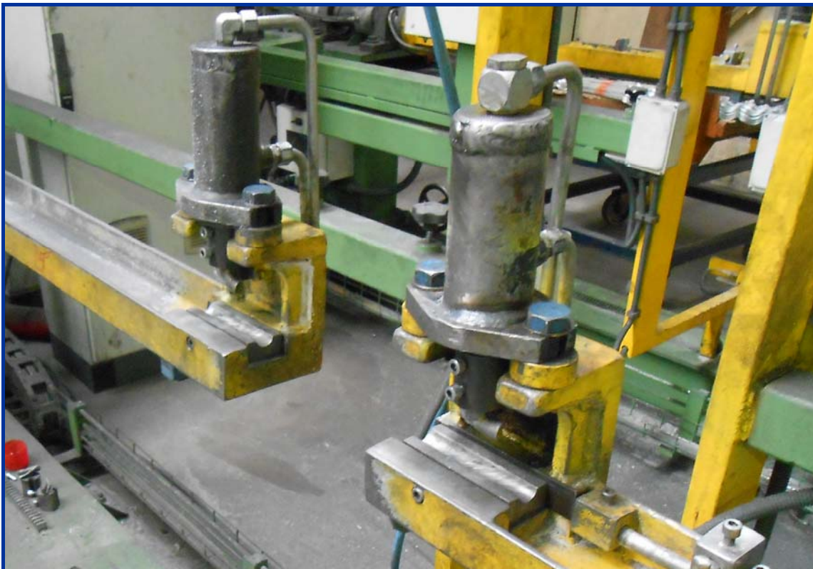
Figura 32. Cableadotas. Detalle del sistema de sujeción de piezas.
