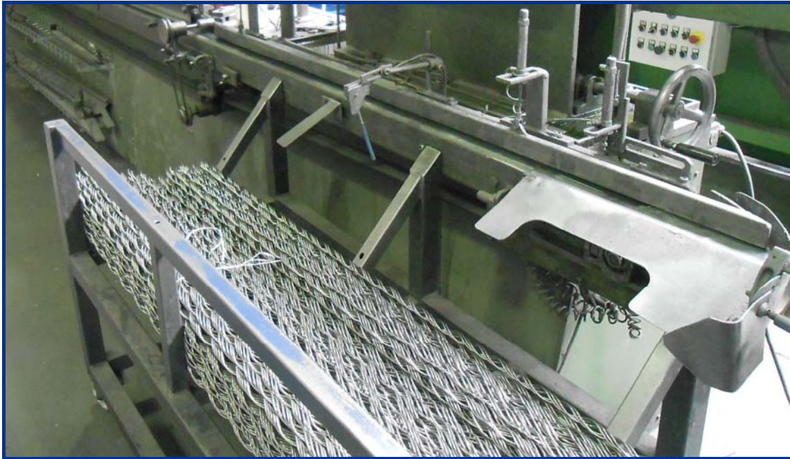
Figura 83. Máquina preformadora para puntas lijadas. Carro para piezas terminadas.
