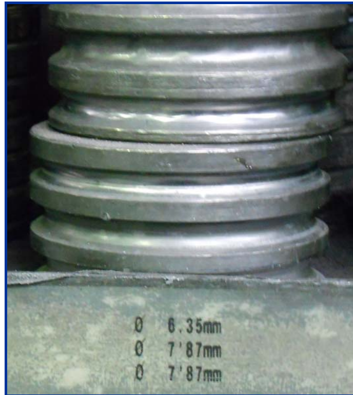
Figura 91. Rodillos de tracción. Detalle de las ranuras.
