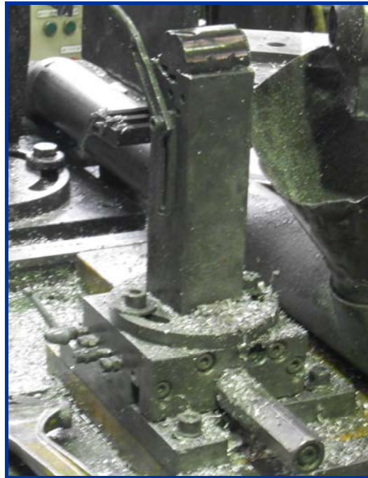
Figura 74. Detalle del ajuste de posición del soporte de varillas para puntas redondas.
