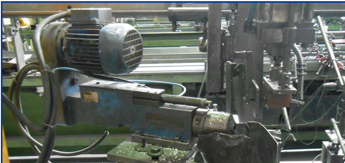
Figura 72. Detalle del mecanismo de acabado de puntas redondas.
