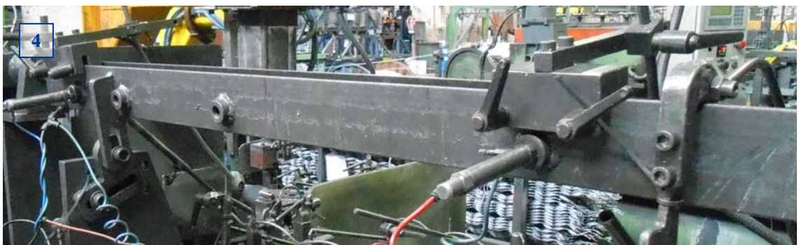
Figura 98. Guías de desplazamiento para encauzadores inferiores (1), rodillo de enhebrado (2), lijadoras (3), y encauzadores superiores y sensor de corte (4).
