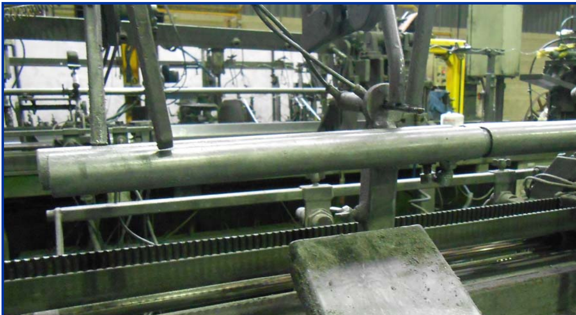
Figura 92. Detalle de la extensión de la longitud de las barras de apoyo.
