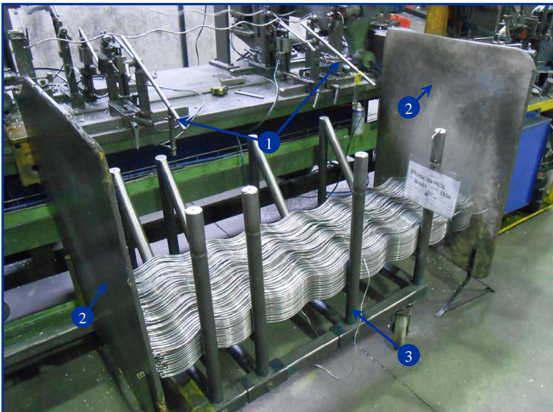
Figura 83. Máquina preformadora para puntas lijadas. Carro para piezas terminadas.
