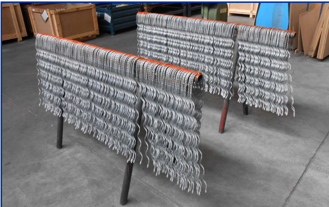
Figura 35. Retenciones de anclaje colocadas sobre caballetes.
