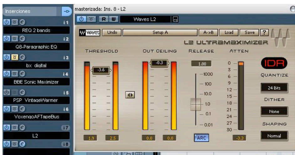
Fig. 3.11. A la izquierda la cadena de inserción y a la derecha el limitador L2 de Waves.
