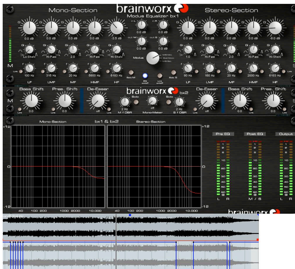
Fig. 3.16. En la parte superior el ecualizador MS Brainworx y en la parte inferior la automatización de éste.
