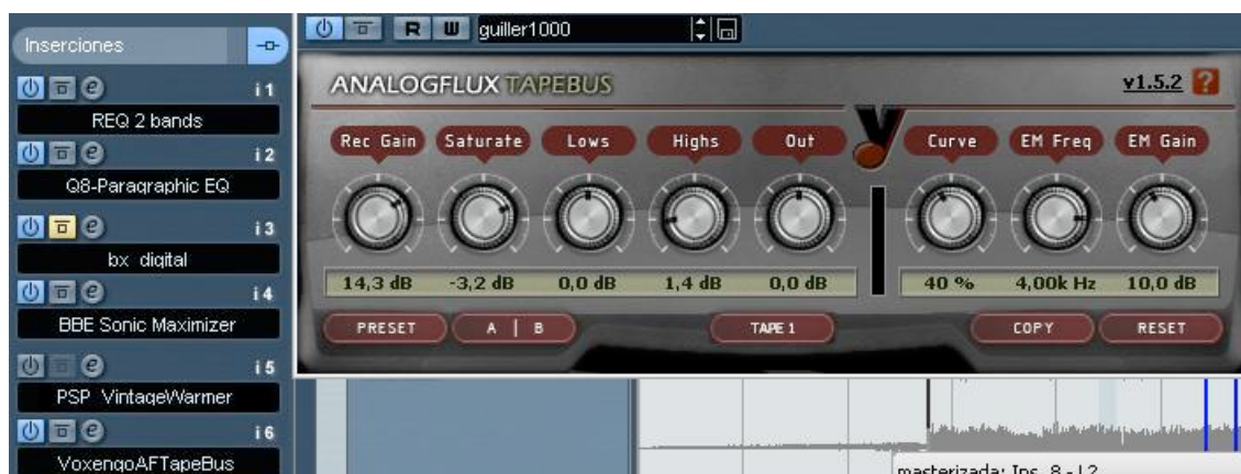
Fig. 3.9. A la izquierda la cadena de inserción y a la derecha el emulador de cinta analógica Analog Flux.
