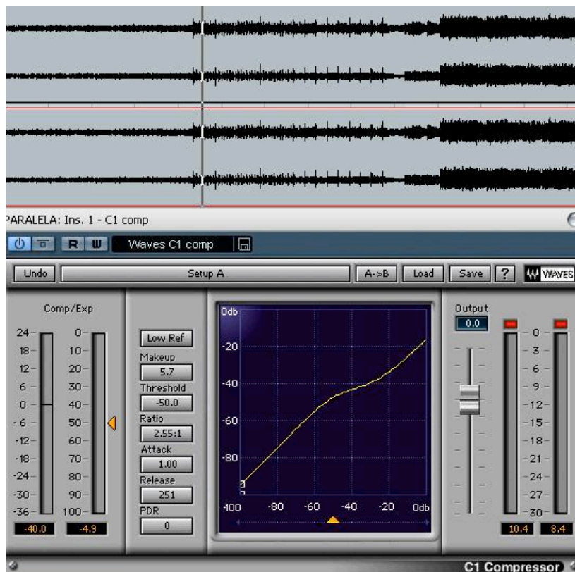
Fig. 3.18. En la parte superior las dos señales, la primera la original y la segunda la que se aplica el compresor paralelo. En la imagen inferior el compresor paralelo Waves C1.
