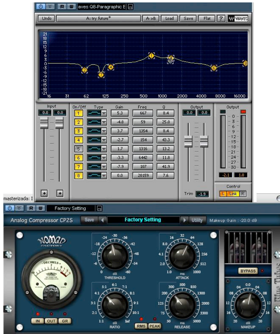
Fig. 3.17. En la parte superior los cambios introducidos en el ecualizador. En la parte inferior el compresor Nomad Factory.
