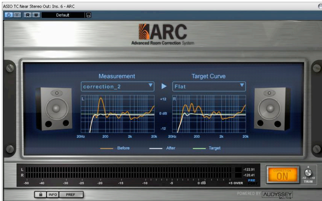
Fig. 2.42. La línea naranja muestra la respuesta en frecuencia que relaciona la sala con los altavoces, y la línea amarilla muestra la corrección realizada.
