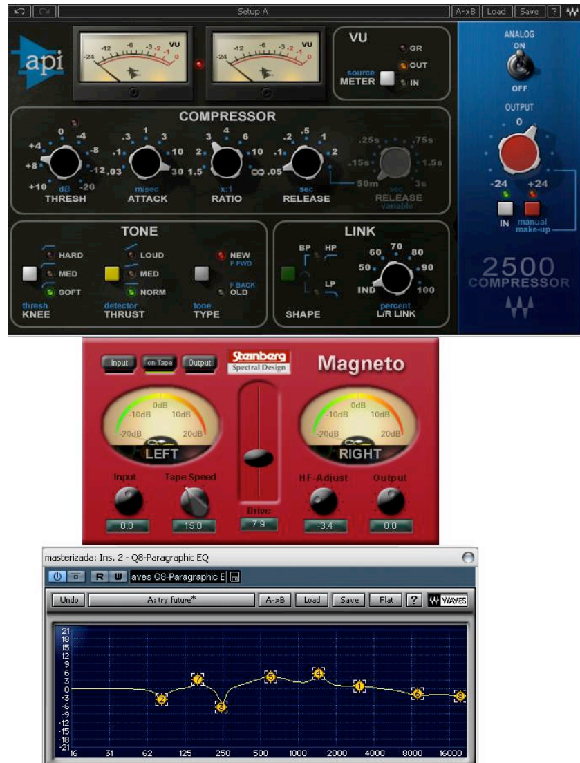
Fig. 3.21. En la parte superior el compresor API 2500. En el centro el Emulador cinta Magneto, y en la parte inferior la nueva ecualización.
