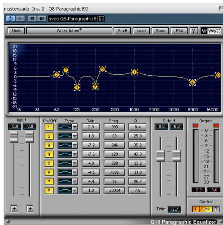
Fig. 3.14. Cambios en el ecualizador tras la comprobación en varios sistemas de reproducción.
