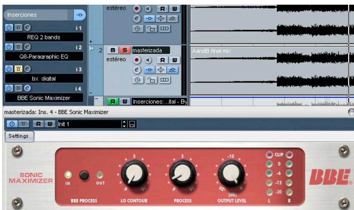
Fig. 3.7. En la parte superior la cadena de inserción. Abajo el maximizador BBe.
