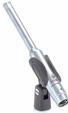
Fig. 2.32. Micrófono de medición Behringer ECM8000.
