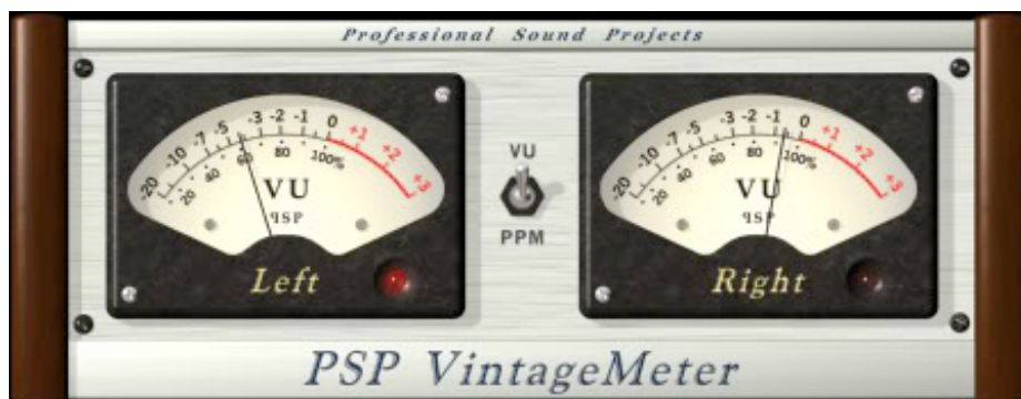
Fig. 2.7. Un Vímetro es una herramienta tan sencilla como útil. El PSP Vintage Meter es un Plug-in gratuito y configurable que le puede dar esta funcionalidad al secuenciador.
