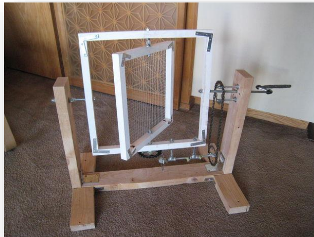
Figura 2: máquina de rotocasting 1 (stlfinder, 2013)
