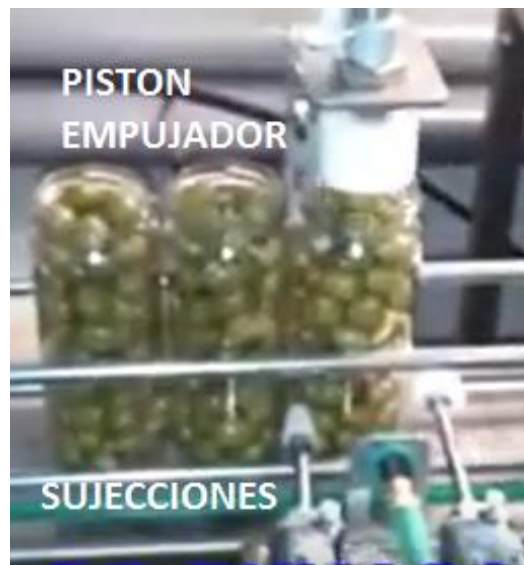
Ilustración 5. Ajuste de llenado con pistón vertical en embotado de aceitunas. (Tecnolactea, 2017)
