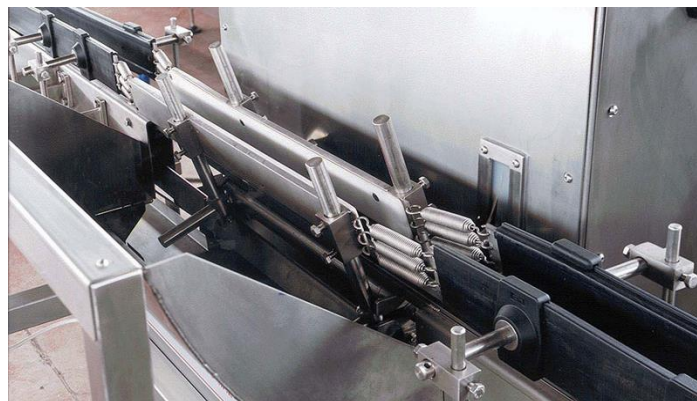
Ilustración 8. Sistema para hacer oscilar el envase contenedor con el producto deseado. (Zilli&Bellini, 2016)
