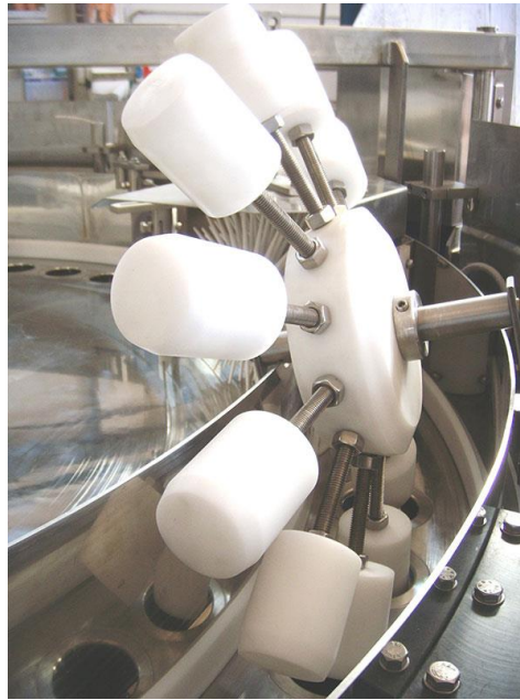
Ilustración 7. Rueda brazada para ajustar llenado de llenadora Zilli&Bellini. (Zilli&Bellini, 2016)
