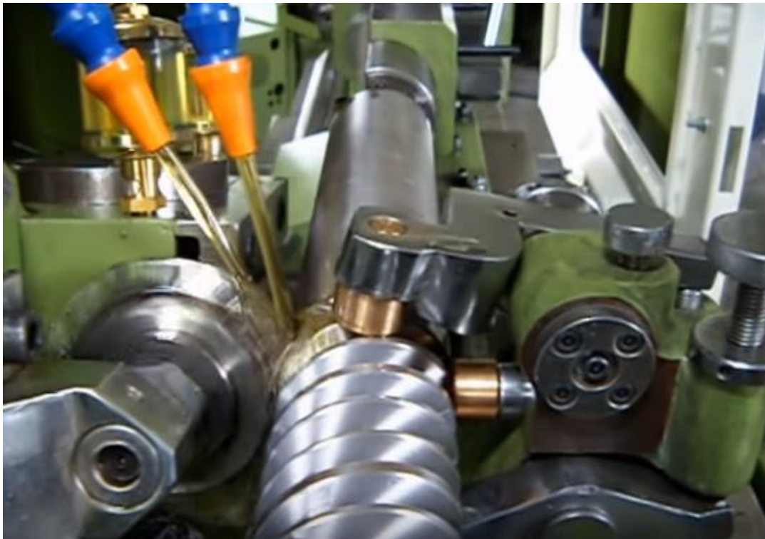
Ilustración 44. Máquina de laminado realizando sinfín (Wu, 2013)
