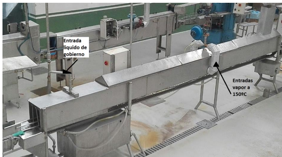
Ilustración 2. Túnel de líquido de gobierno y calentador
