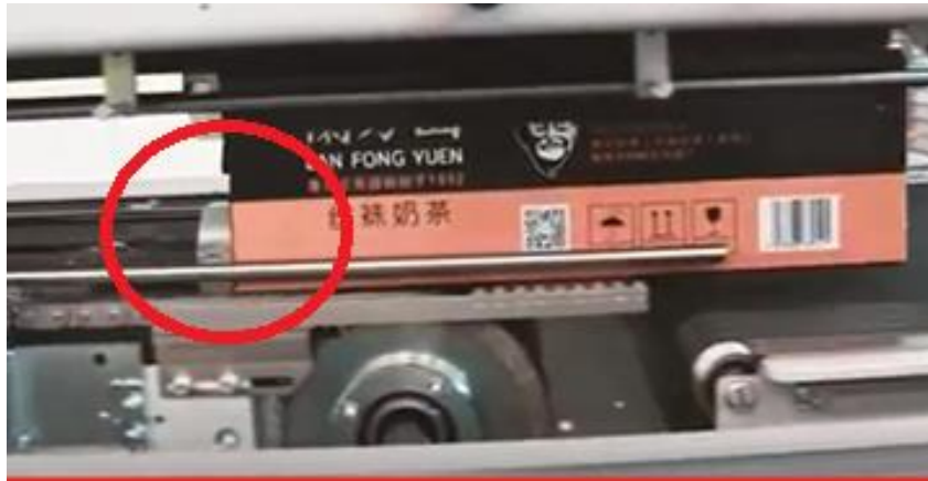
Ilustración 12. Cinta con pletinas para sujeción de cajas de cartón
