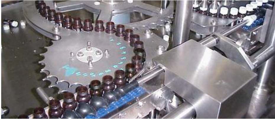
Ilustración 10. Sistema estrella para sujetar y guiar frascos. (Comas-machines, 2012)
