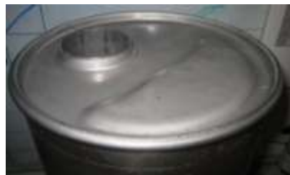
Imagen 4.18 Conjunto extraído de cerradora. Borde realizado por la cerradora
