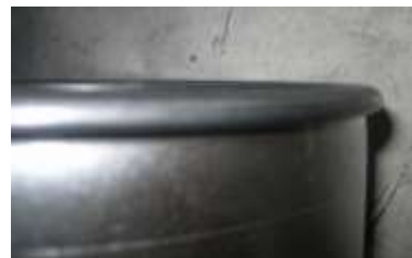
Imagen 4.18 Conjunto extraído de cerradora. Borde realizado por la cerradora
