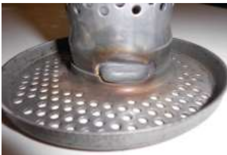
Imagen 4.8 Soldadura tubo interior-tapa interior
