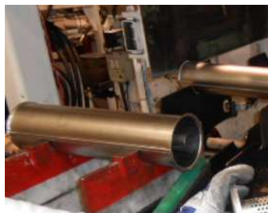
Imagen 4.13 Conjunto final obtenido en la agrafadora, pestañadora e introductora
