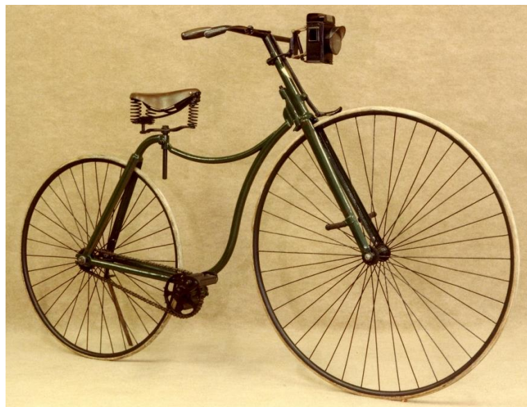
Figura 6. Bicicleta de seguridad (safety bicycle)
