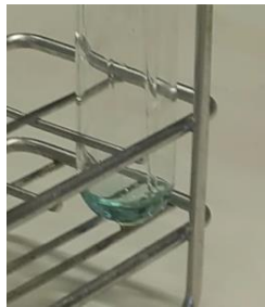
Figura 7: Dispositivo de detección de alcohol en aire espirado. Cantidad exacta de la disolución ácida para detectar el límite de alcohol permitido en aire espirado. Figura tomada en el laboratorio.
