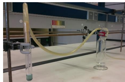
Figura 8 y 9: Dispositivo de detección de alcohol en aire espirado. Con una cantidad de disolución ácida seis veces superior a la necesaria para detectar el límite de alcohol permitido en aire espirado. La primera antes de burbujear alcohol y la segunda después. Figuras tomadas en el laboratorio.
