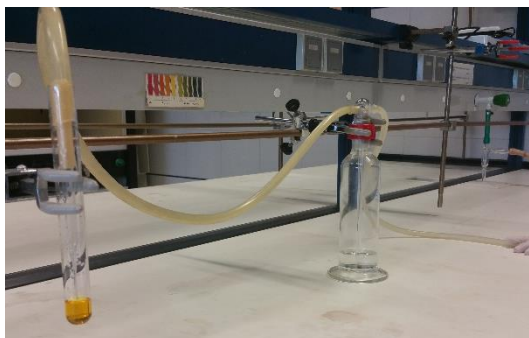
Figura 5: Dispositivo de detección de alcohol en aire espirado. Figura tomada en el laboratorio.
