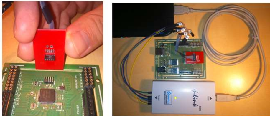
Figura 7.5. Adaptador al conector JTAG/SWD y programador J-Link EDU
