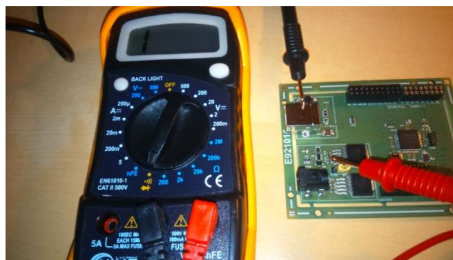
Figura 7.1. Verificación de las pistas y planos mediante un multímetro
