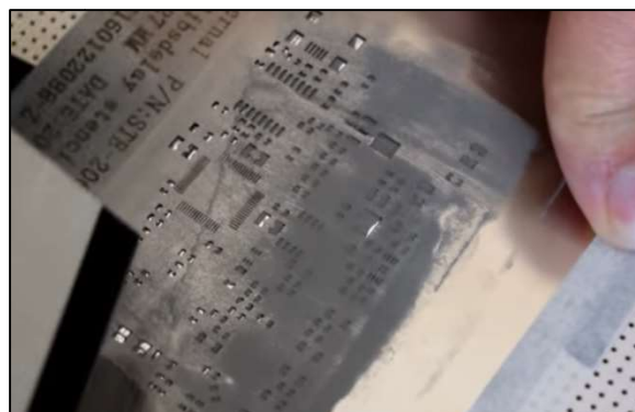
Figura 6.7. Extensión de la pasta de soldadura sobre el Stencil con una espátula: https://www.youtube.com/watch?v=bSnb3D72pxY
