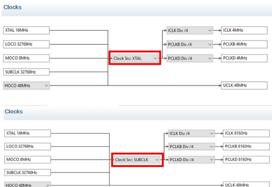
Figura 7.8. Configuración de los relojes internos y de las fuentes de los osciladores
