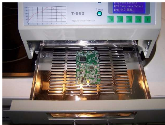
Figura 6.9. Introducción de la PCB en el horno de soldadura SMD
