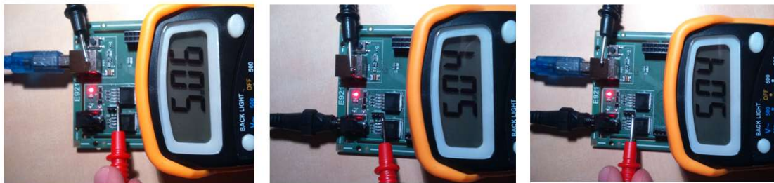
Figura 7.3. Tensión en la net '5V' en los tres modos de alimentación
