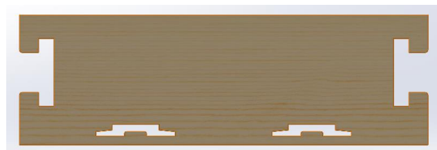
Figura 2.5. Lateral caja de madera con 2 ranuras en la parte inferior (Dimensiones según el modelo)
