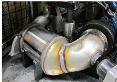
Fig. 21: Subconjunto cargado en fugómetro
