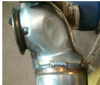
Fig. 23: Puntos de soldadura manual
