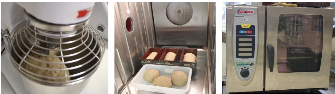
Figura 6. Principales equipos para la elaboración de pan, amasadora, cámara climática y horno
