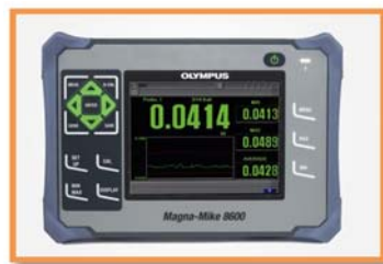
Figura 15: Medidor de espesores Magna- Mike 866. Fuente: catálogo de Magna Mike 866.
