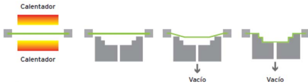
Figura 6 Esquema del proceso de termo conformado. Fuente de: www. Aimplas.es .
