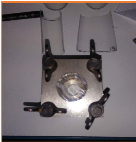
Figura 24: Bastidor y punzón que se utilizan en el ensayo. Fuente: imagen propia..
