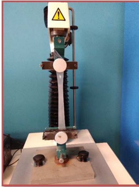
Figura 18: Máquina para ensayo de tracción. Fuente: Imagen propia.
