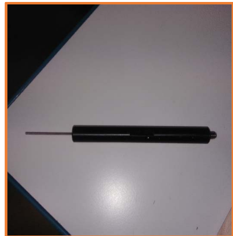
Figura 24: Bastidor y punzón que se utilizan en el ensayo. Fuente: imagen propia..
