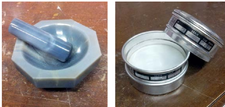
Figura 2.7: Fotografía del mortero de ágata (izquierda) y el tamiz de 63 y 100 \mu\text{m} (derecha) utilizado.
