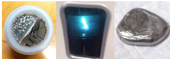
Figura 2.5: Comparativa del estado de la aleación antes de introducir en el horno con los elementos puros (izquierda), la aleación en el horno (centro) y la aleación al final del proceso tras varias fundidas y lijada (derecha).
