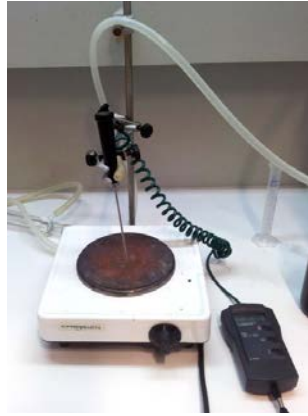
Figura 2.19: Fotografía de la placa calefactora y el termopar utilizado.
