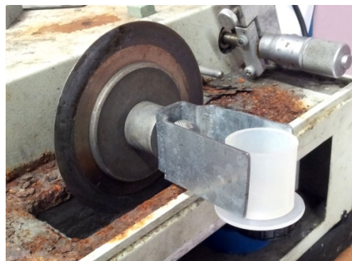
Figura 2.22: Fotografía del sistema utilizado para mantener el polvo homogéneamente distribuido.
