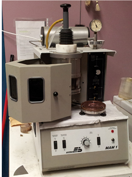
Figura 2.4: Fotografía del horno de arco utilizado.
