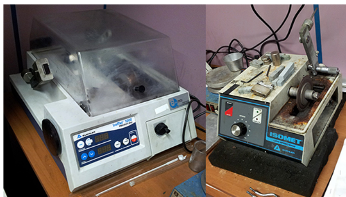
Figura 2.1: Fotografía de las dos sierras: Buehler Isomet 1000 Precision Saw (izquierda) y Buehler Isomet Low Speed Saw (derecha)
