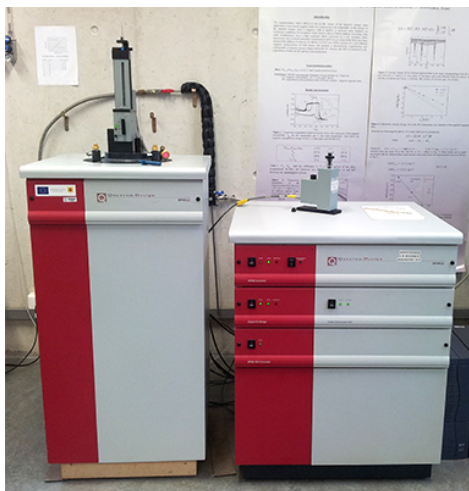
Figura 2.12: Magnetómetro SQUID con el que se han realizado las mediciones correspondientes.
