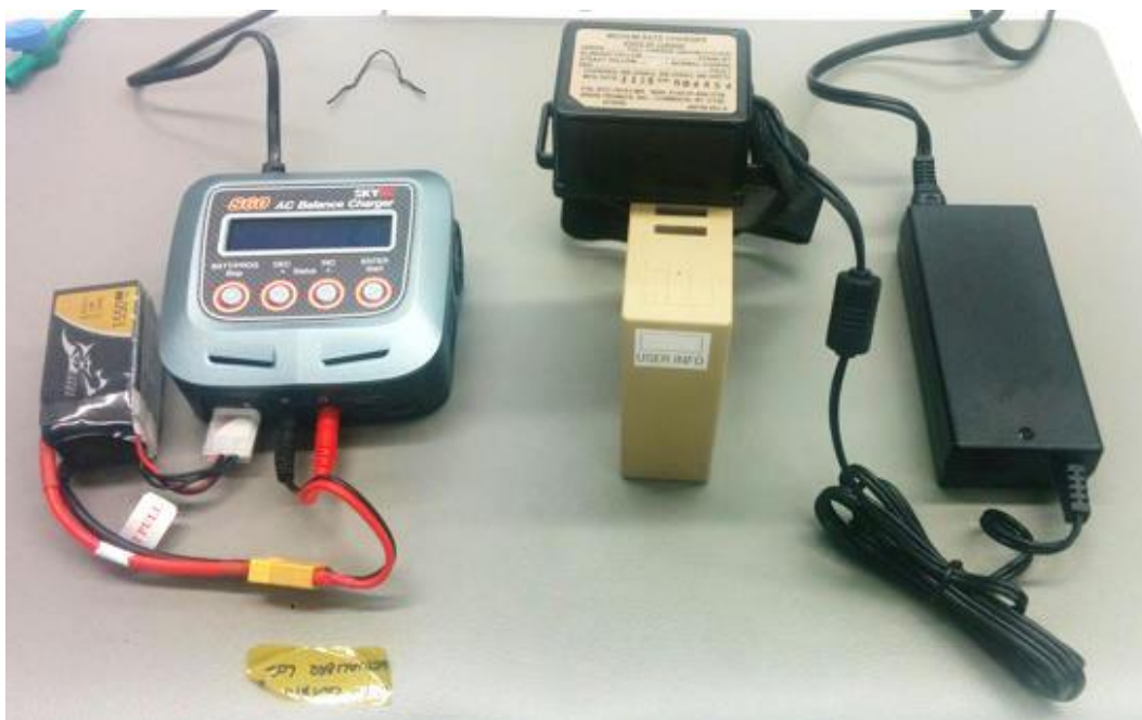
Figura 21: Baterías utilizadas para el DL y la GS con sus cargadores correspondientes
