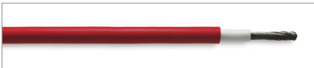
*Conductor de cobre electrolítico estañado, flexibilidad clase V, aislamiento goma libre de halógenos tipo EI-6 y cubierta exterior de goma libre de halógenos y baja emisión de humos tipo EM-8. Colores rojo o negro.*
