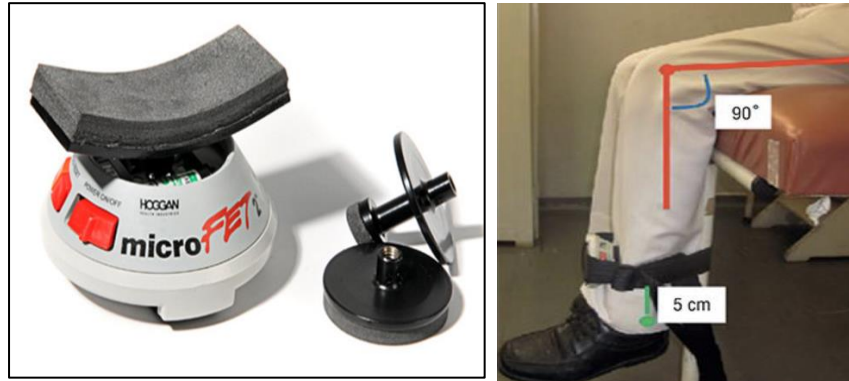
Figura 22. Dinamómetro de mano empleado en la evaluación de la fuerza muscular ( modelo micro FET2 (Hoggan®) a la derecha. A la izquierda de la figura, forma de medir la fuerza del cuádriceps mediante dinamometría.
