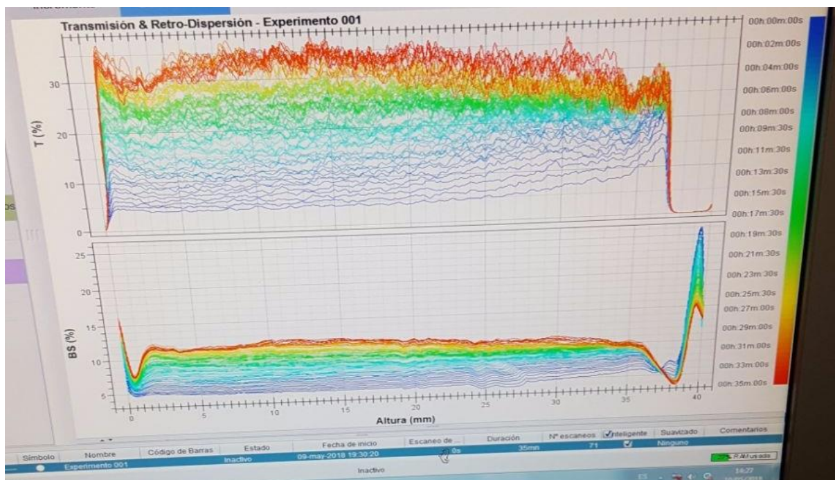
Figura 10: Floculación en las pruebas posteriores a la atomización en las soluciones con material de pared.
