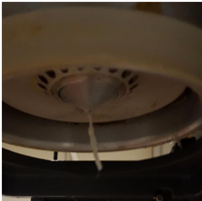
Figura 11: Obstrucción en la aguja.
