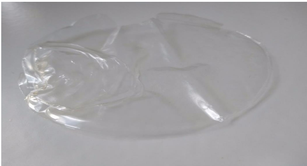
Figura 16: Film de B-glucano obtenido con 10 ml de solución al 1,5 % w/v en la estufa a 46 ° C durante 24 h.
