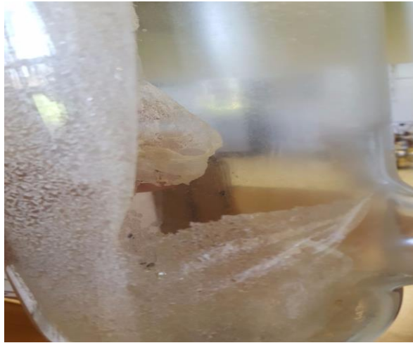
Figura 4: Film formado en las paredes del ciclón del spray-dryer debido a un secado ineficaz, provoca una gran pérdida del rendimiento y en ocasiones obstrucciones.
