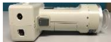
Figura 3. Colorímetro Minolta CM-2002 usado en las medidas del presente trabajo.
