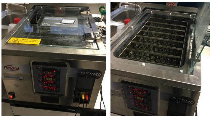
Figura 1. Baño de cocción y sondas de temperatura.
