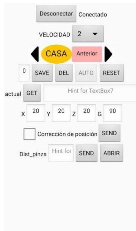
Figura 50 App para control del robot en smartphone. Pantalla cuando está conectado y en control con coordenadas xyz
