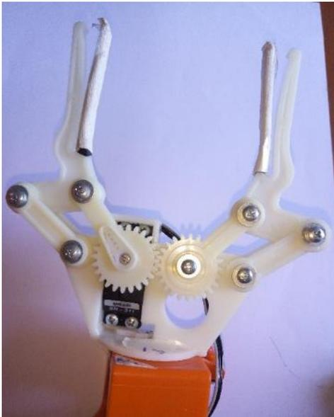
Figura 13 Pinza en posición abierta.
