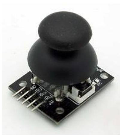
Figura 19 Joystick para Arduino. Fuente: <https://www.prometec.net/joystick-servo/>
