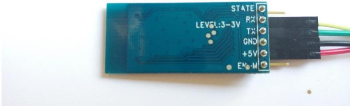
Figura 17 Módulo bluetooth. La parte trasera con los nombres de los pines.
