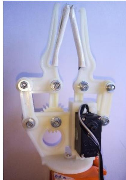
Figura 14 Pinza cerrada completamente.
