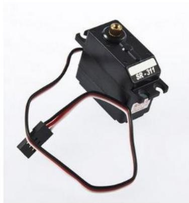
Figura 9 Imagen del servomotor SR311.
