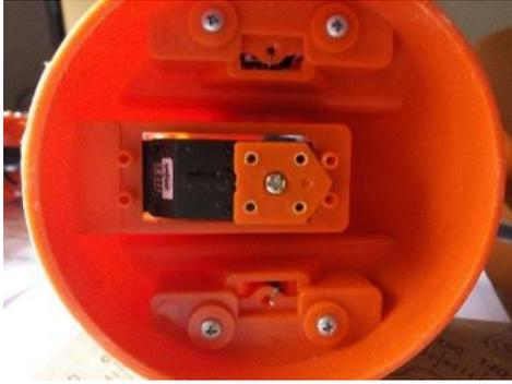
Figura 54 Conjunto eslabón base con servomotor.
