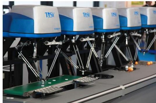
Figura 1 Robot DELTA realizando un proceso de colocación. Fuente: <http://wiki.robotica.webs.upv.es/wiki-de-robotica/introduccion/clasificacion-de-robots/>
