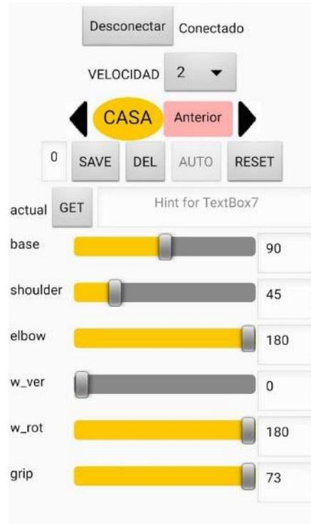
Figura 52 App para control del robot en smartphone. Pantalla cuando está conectado y en control con ángulos.
