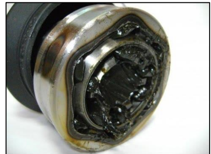
Figura 31. Junta usada con grasa.
