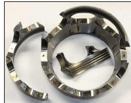
Figura 37. Caso de rotura de una Jaula.
