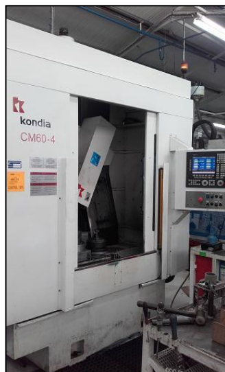
Figura 40. Centro de mecanizado para el rectificado de las pistas de las manguetas.
