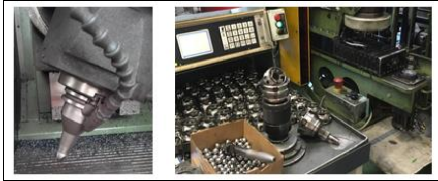
Figura 41. Herramienta de rectificado de pistas y puesto de montaje de Juntas.
