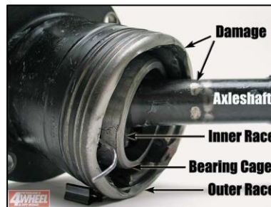
Figura 13. Ejemplo de transmisión dañada.
