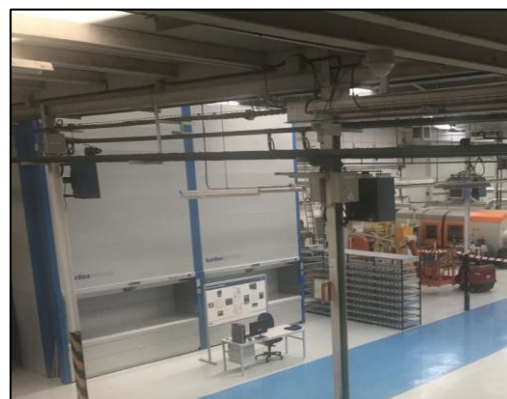
Figura 93. Fases del proceso de implantación de la Zona de Cambio de Utillajes: Torres de almacenamiento, estanterías dinámicas y puesto del operario.
