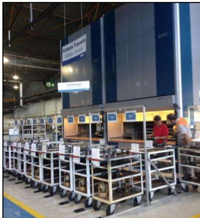
Figura 78. Preparación de los carros de utillajes almacenados en las nuevas Torres automatizadas.
