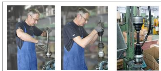
Figura 44. Pasos de montaje para una transmisión.
