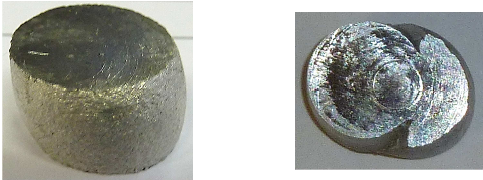
Figura 2.13. Anisotropía presente en las muestras comprimidas procesadas por ECAE.
