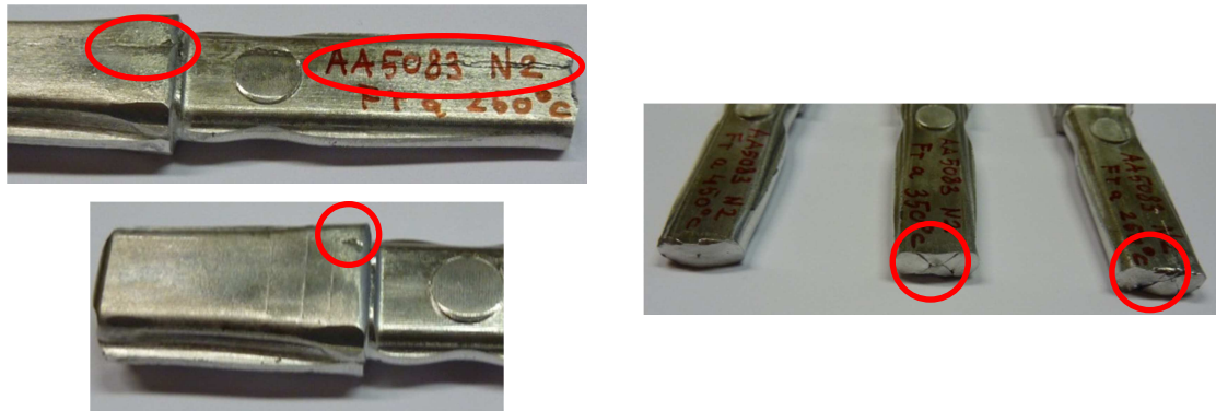
Figura 7.3. Grietas externas de los álabes con material de partida en estado N2.
