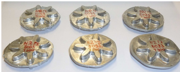
Figura 6.19. Diferentes muestras de los ensayos de forja isoterma del engranaje.
