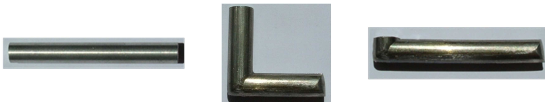
Figura 4.1. Procesado de probetas mediante ECAE.
