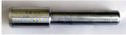
Figura 6.1. Probeta inicial para la forja del álabe plano.
