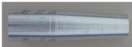
Figura 6.10. Probeta inicial para la forja del álabe curvado tipo Francis.
