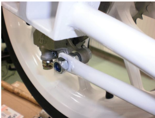
Detalle de la pinza de freno trasera
