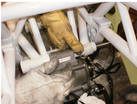
Colocación del eje del basculante
