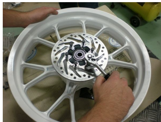
Colocación del disco de freno trasero
