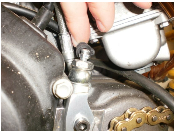
Foto de detalle del sangrador del embrague
