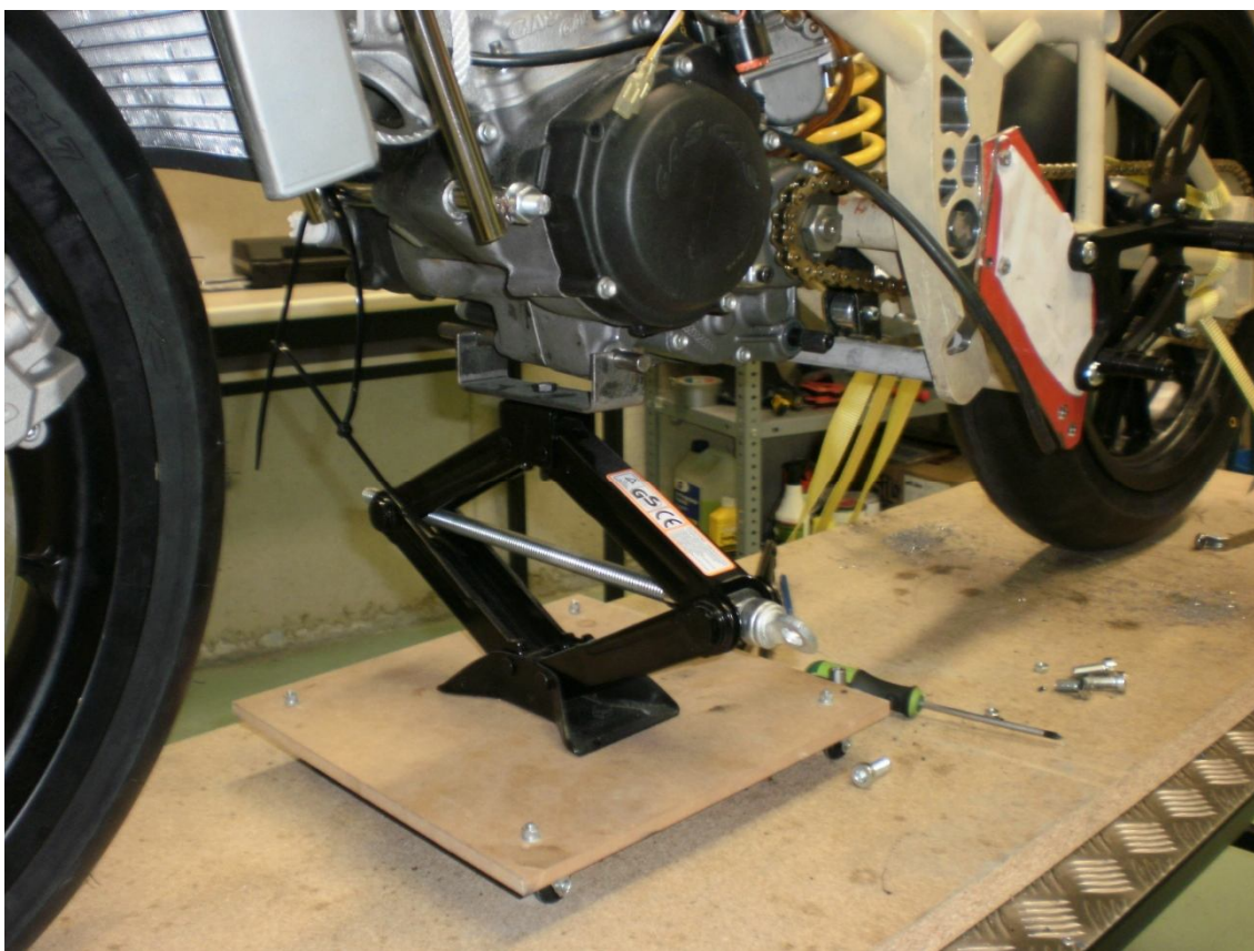
Utillaje para la sujeción y manipulación del motor
