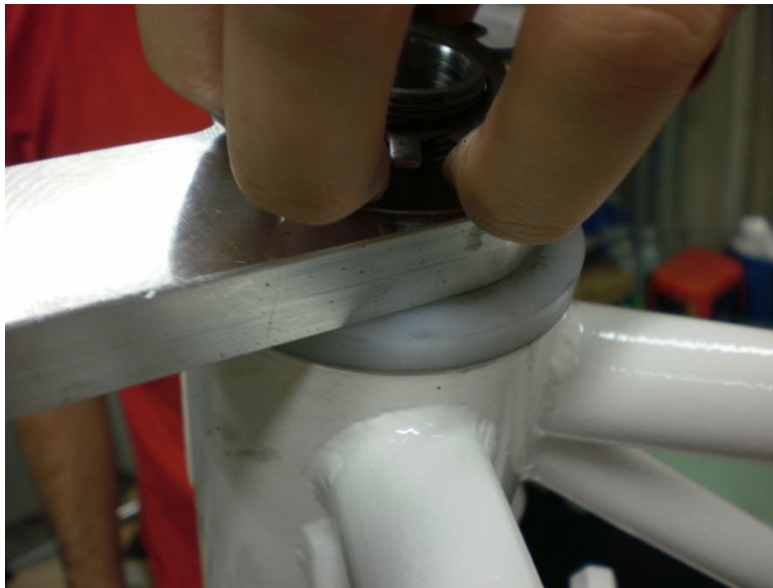
Arandela de nylon del eje de la dirección
