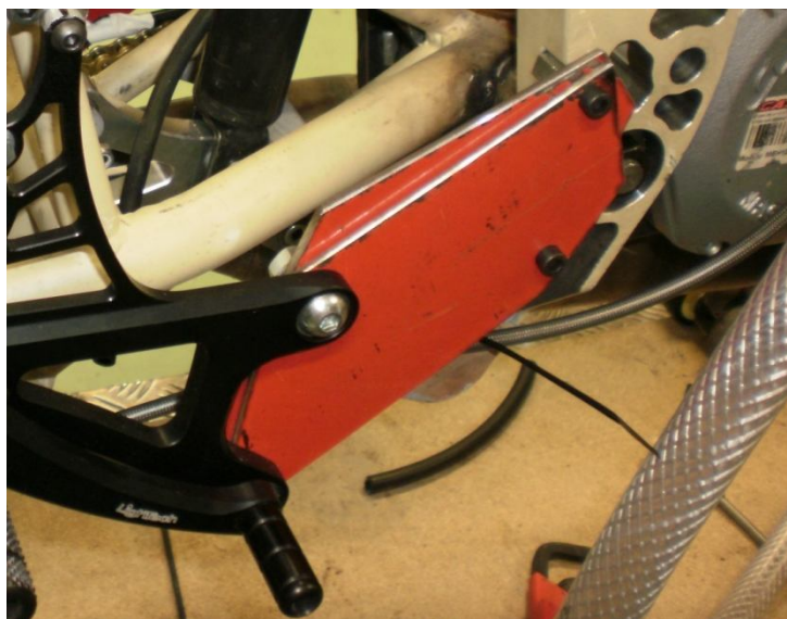
Prototipo del enlace de la estribera al bastidor
