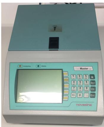
Figura 15. Medidor de actividad de agua ( $A_w$ ).
