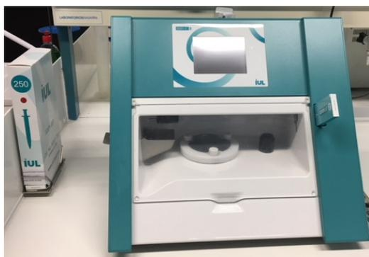
**Figura 11. Sembrador automático Eddy Jet 2 (IUL, España).**
