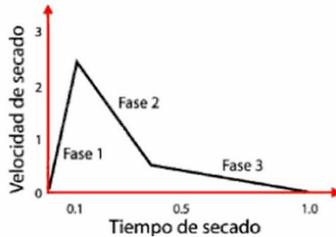
**Figura 6. Etapas del proceso de liofilización (Orrego Alzate, 2008).**
