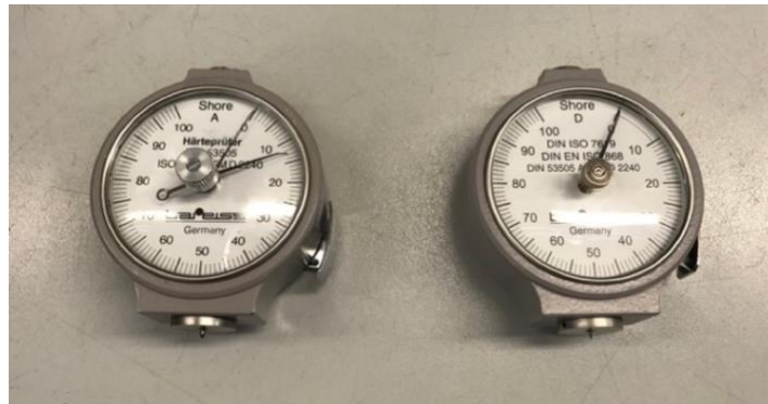
Figura 33. Medidores Shore "In Situ".
