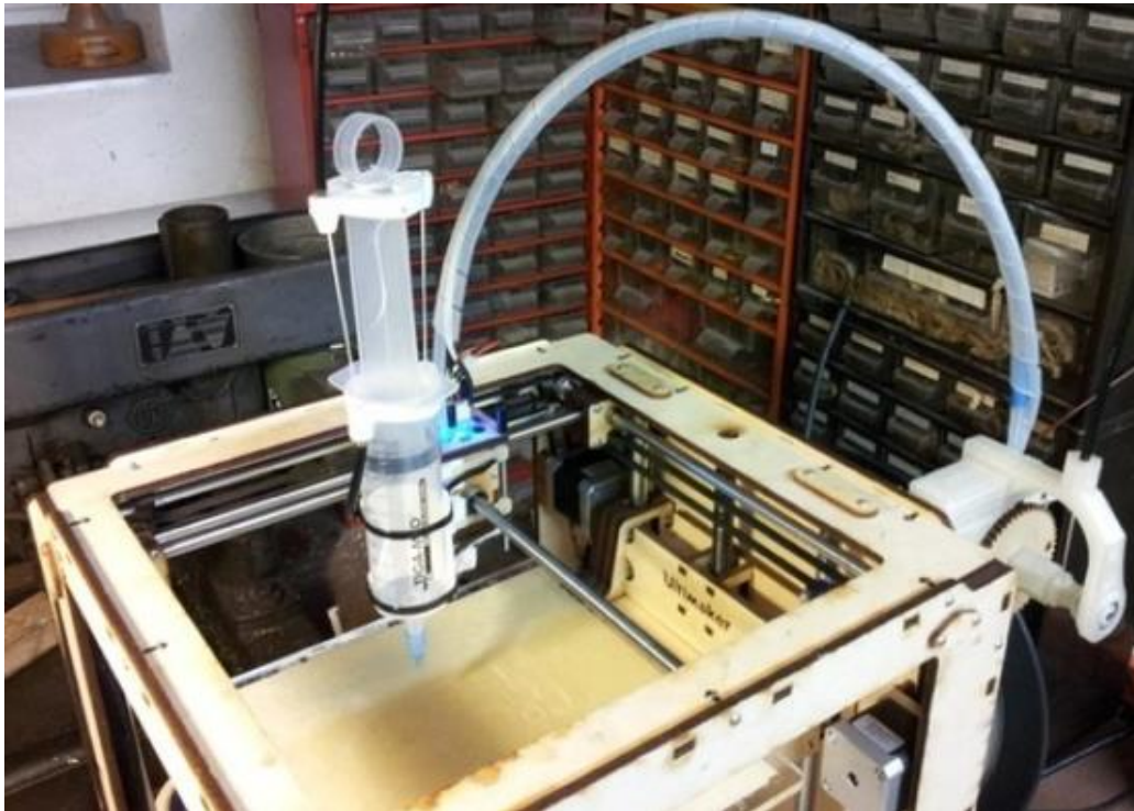
Figura 20. Impresora con extrusor de jeringa.
