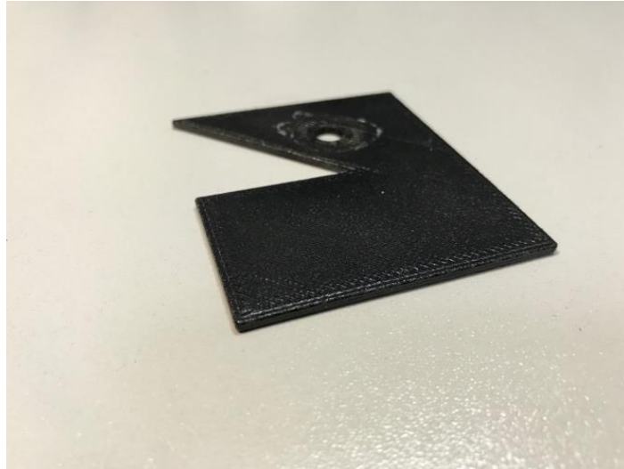
Figura 51. Plantilla HIPS sin deformación alguna después del ensayo.
