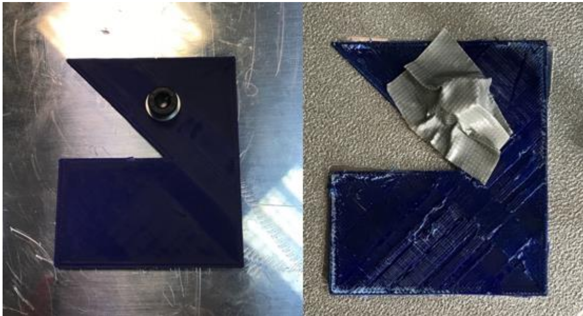
Figura 37. Plantilla de ABS antes y después del ensayo respectivamente.
