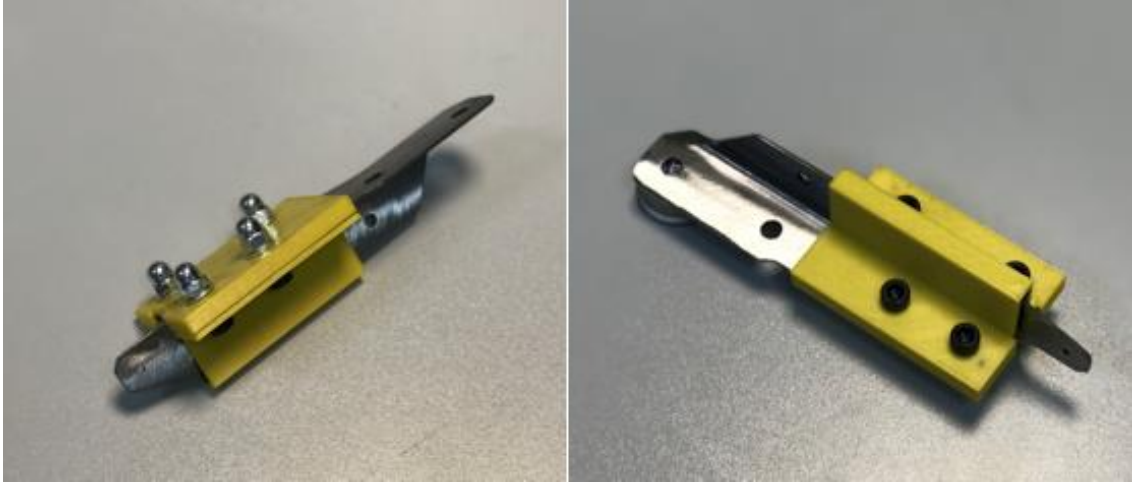
Figura 61. Pieza y útil con sus elementos de fijación.
