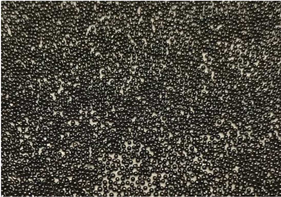
Figura 7. Perdigón esférico para aviación.
