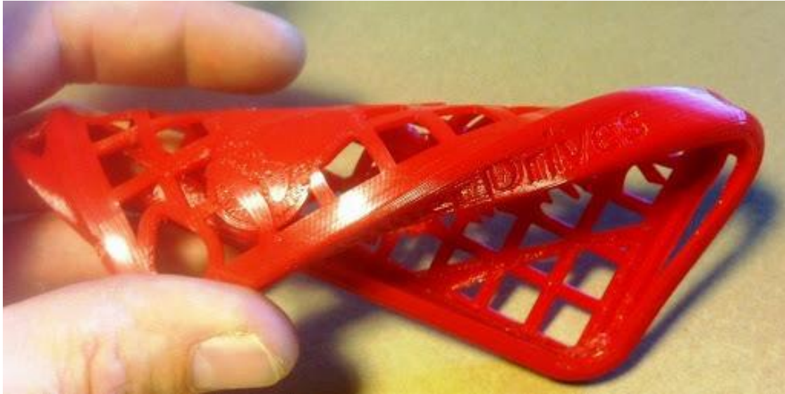
Figura 26. Muestra de la flexibilidad del Ninjaflex.
