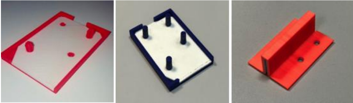
Figura 60. Útiles inferiores de "click" y cilindro (izquierda) y útil superior de fijación (derecha).
