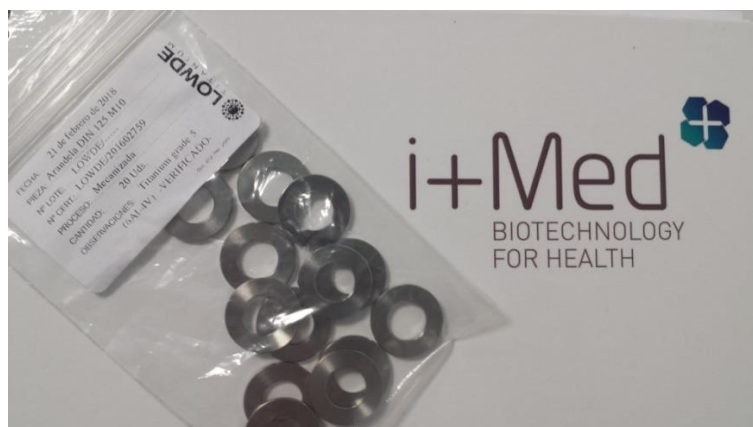
Figura 29: Arandelas de titanio grado 5 empleadas
