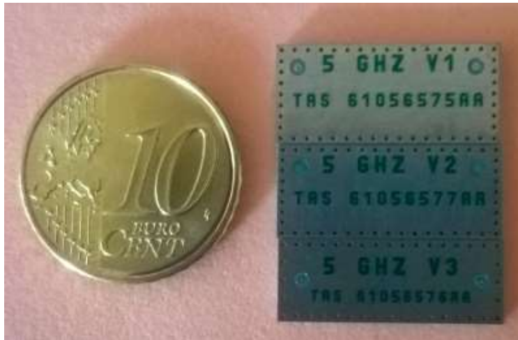
Figura 3.17: Fotografía de los filtros stripline V1, V2 y V3 construidos por Thales
