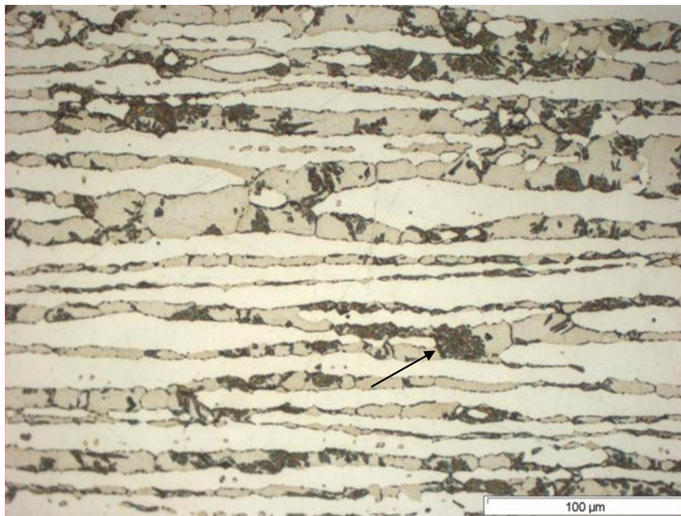
Figura 4. 23. M25: 850°C-25 min y temple en agua (18,62% fase sigma)
