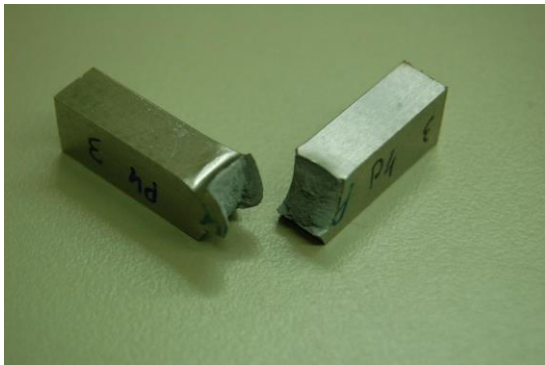
c) M15 (0,22% Fase \sigma ): Fractura dúctil
