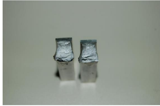
b) ST (0% Fase \sigma ): Fractura dúctil
