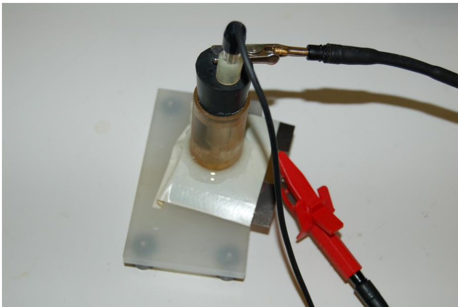
Figura 3. 37. Detalle del montaje de la celda electroquímica
