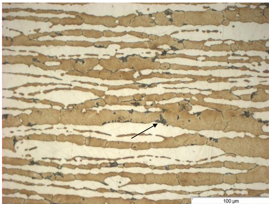
Figura 4. 22. M21: 850°C-21 min y temple en agua (5,19% fase sigma)
