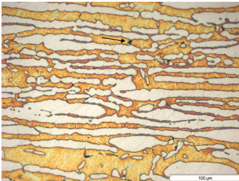
Figura 4. 19. M15: 850°C-15 min y temple en agua (0,22% fase sigma)
