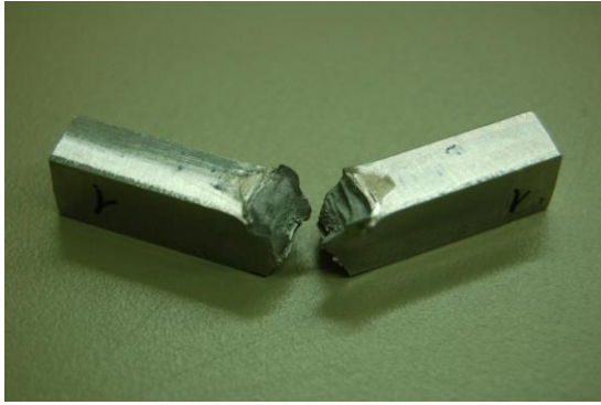
a) ST (0% Fase \sigma ): Fractura dúctil
