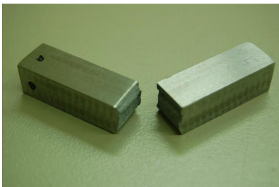
g) M25 (18,62% Fase \sigma ): Fractura frágil
