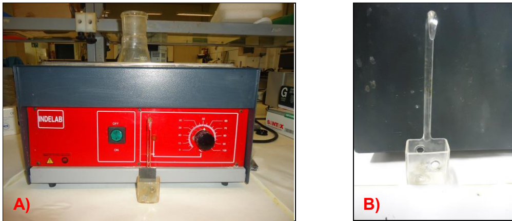
Figura 3. 30. A) Baño térmico empleado para el ensayo B) Portaprobetas para ensayo según norma ASTM G48
