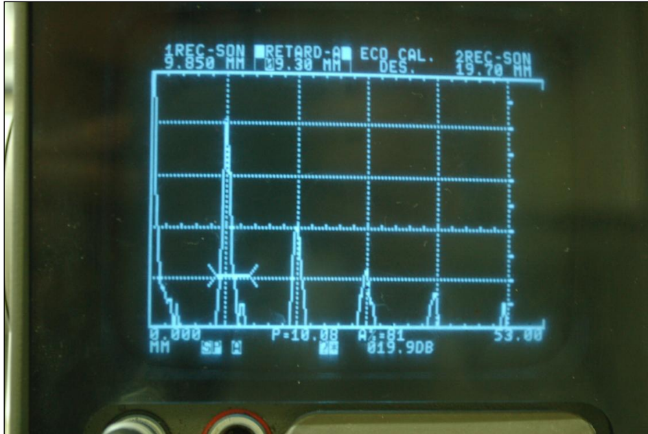
Figura 4. 113. Ecopulsos registrados en la muestra M17
