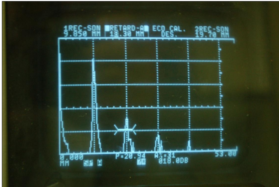
Figura 4. 117. Ecopulsos registrados en la muestra M25
