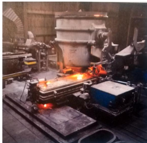
Figura 2. 40. Proceso de colada continua [40]
