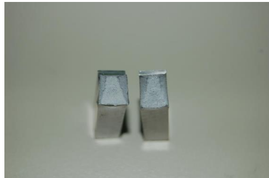
d) M15 (0,22% Fase \sigma ): Fractura dúctil
