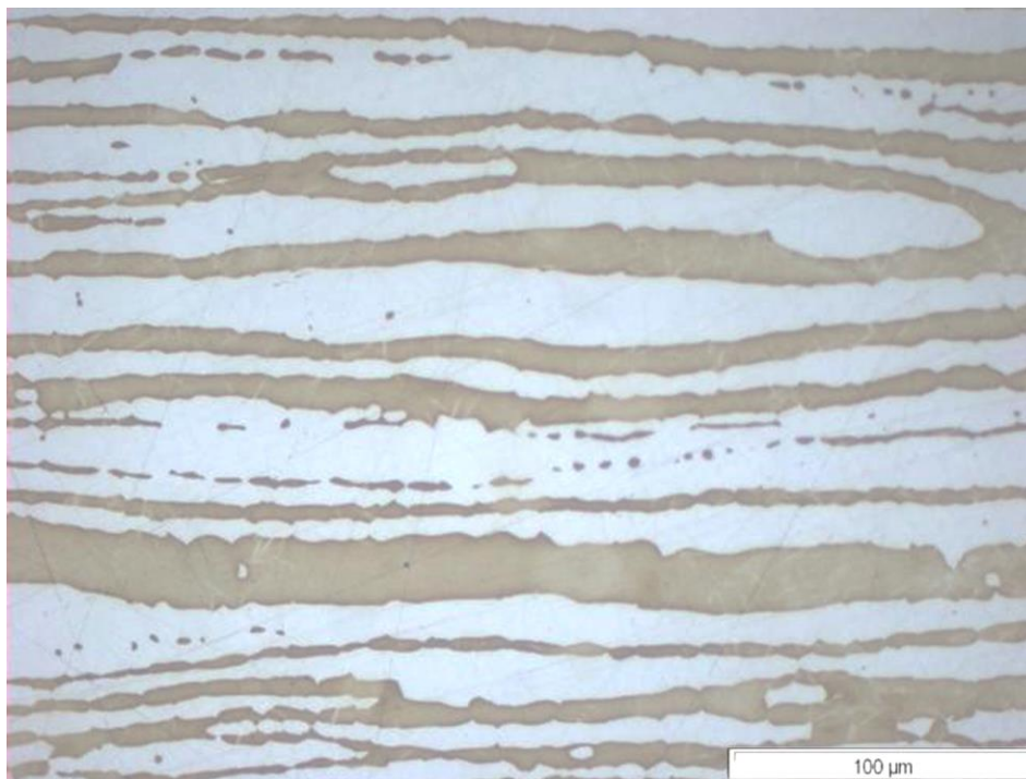
Figura 4. 15. ER: Muestra en estado de recepción (0% de fase sigma)
