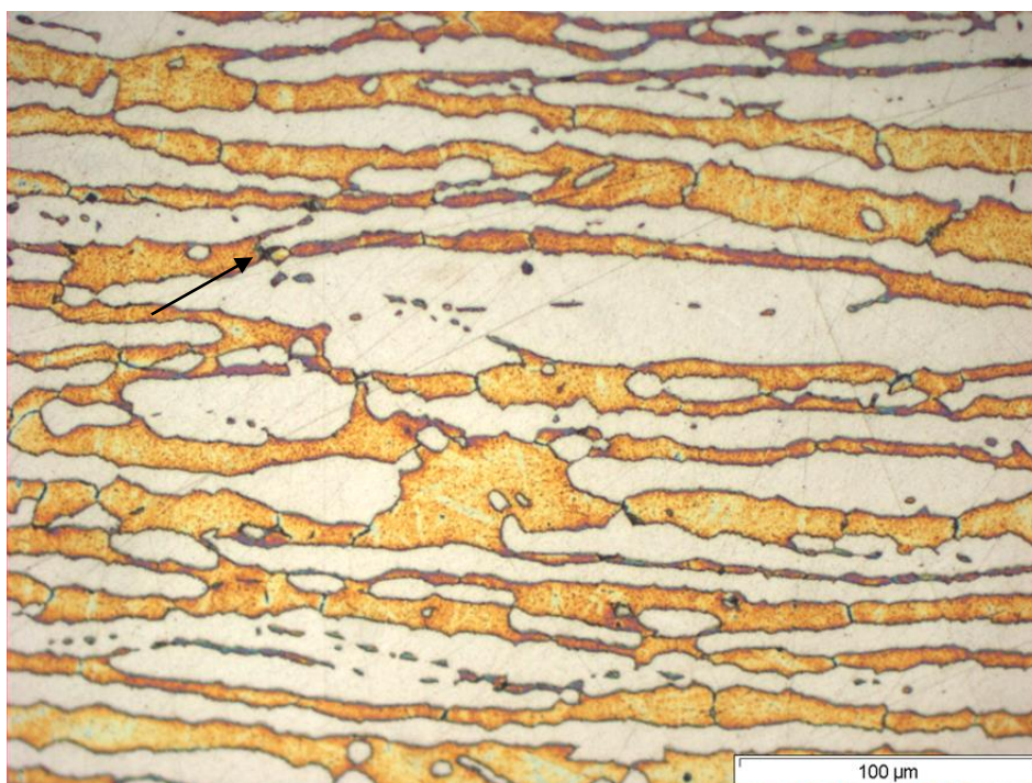
Figura 4. 18. M14: 850°C-14 min y temple en agua (0,14% fase sigma)
