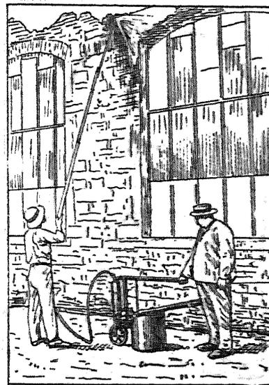
Fig. 1.ª — Desinfección con un pulverizador de carretilla
