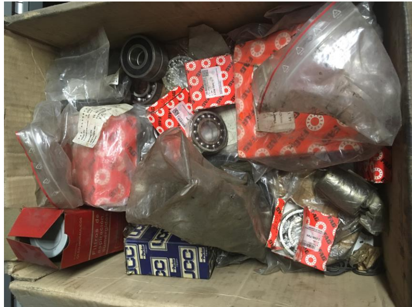
Ilustración 38. Rodamientos mezclados en una misma caja.
