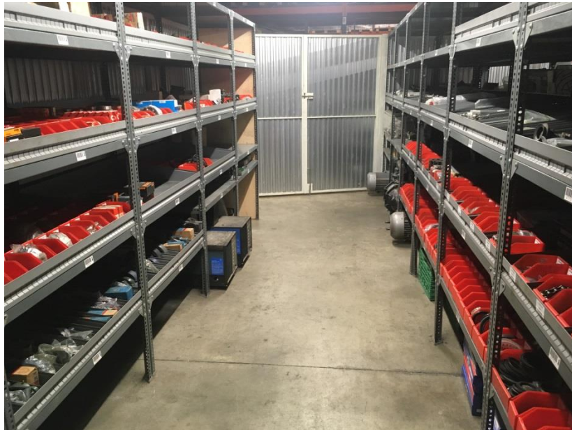
Ilustración 46. Almacén de taller después de implantar las dos primeras S's.
