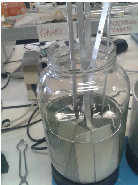
Figura 8.20: Imagen de la realización del sellado
