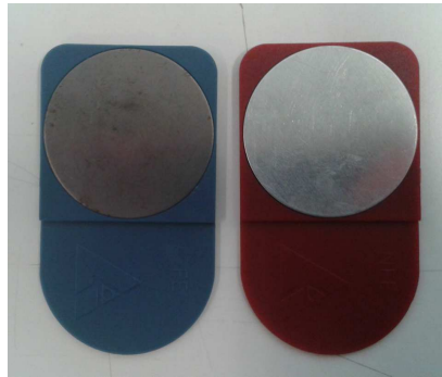
Figura 8.25: Placas base que se pueden utilizar para realizar la calibración del instrumento
