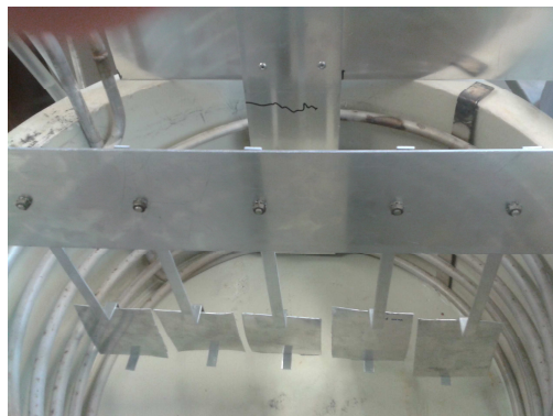
Figura 8.12: Fotografía que muestra la disposición en la que quedarán las piezas a anodizar dentro de la cuba
