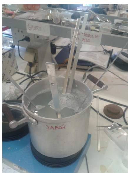
Figura 8.14: Imagen de la realización del desengrase
