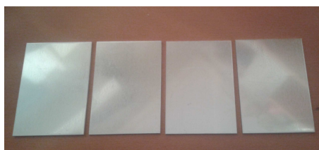
Figura 8.10: Cuatro de las muestras que serán anodizadas
