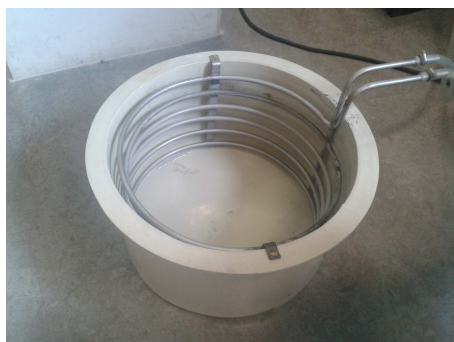
Figura 8.5: Imagen en la que se muestra la cuba y el sistema de refrigeración en su interior
