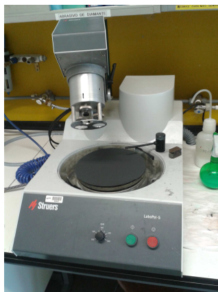
Figura 8.35: Pulidora automática de la marca Struers LaboPol-5
