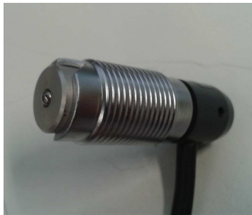
Figura 8.24: Imagen de la sonda en contacto con la muestra de aluminio
