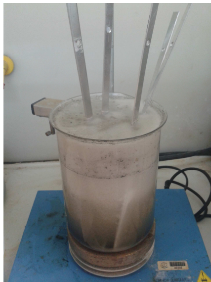
Figura 8.15: Imagen de la realización del ataque cáustico sobre las piezas
