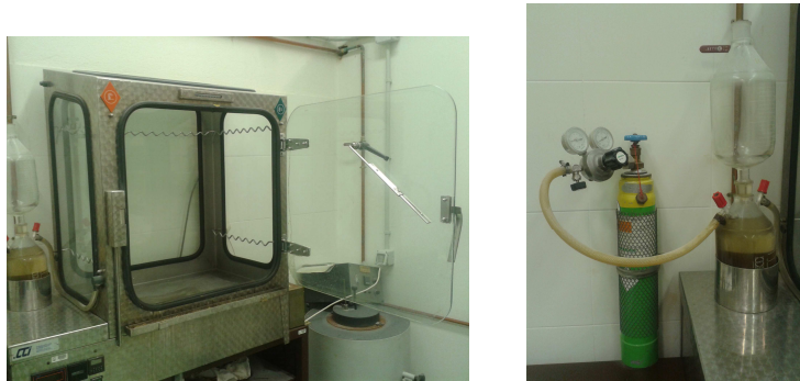
Figura 8.49: Equipo utilizado para el ensayo de corrosión compuesto por la cámara y la fuente de dióxido de azufre
