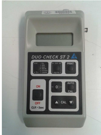
Figura 8.23: Imagen del instrumento utilizado para la medición de espesores
