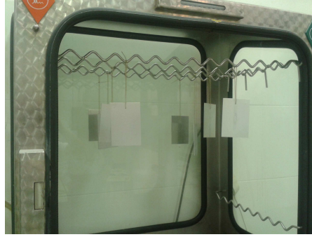
Figura 8.50: Colocación de las piezas en el interior de la cámara del equipo de corrosión
