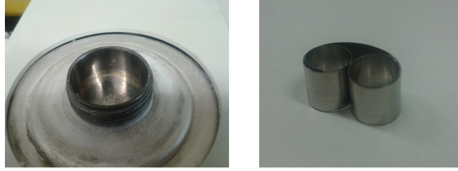
Figura 8.31: Imagen de la cavidad donde se introduce la muestra así como los muelles utilizados para sujetarla en posición vertical
