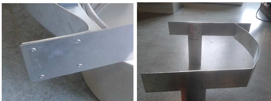
Figura 8.9: Detalle de la unión correspondiente al embarrado donde conecta la pinza (izquierda) y unión de los cátodos verticales (derecha)
