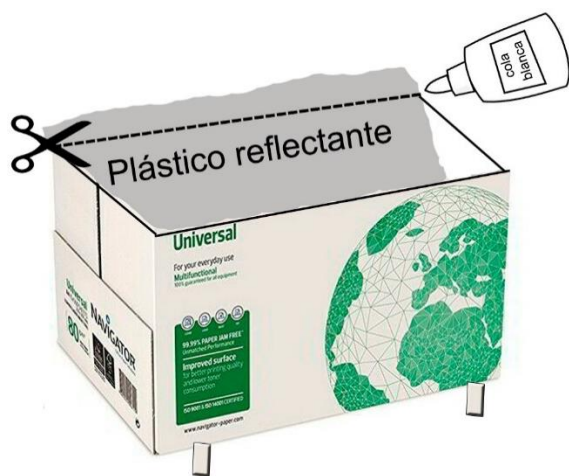
Ilustración 14. Forrar con plástico reflectante el interior de la caja de DIN A4. Fuente: Pablo Ausejo.
