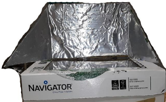
Ilustración 19. Escuadras unidas a la solapa de la tapa mediante una pieza de plástico reflectante. Fuente: Pablo Ausejo.
