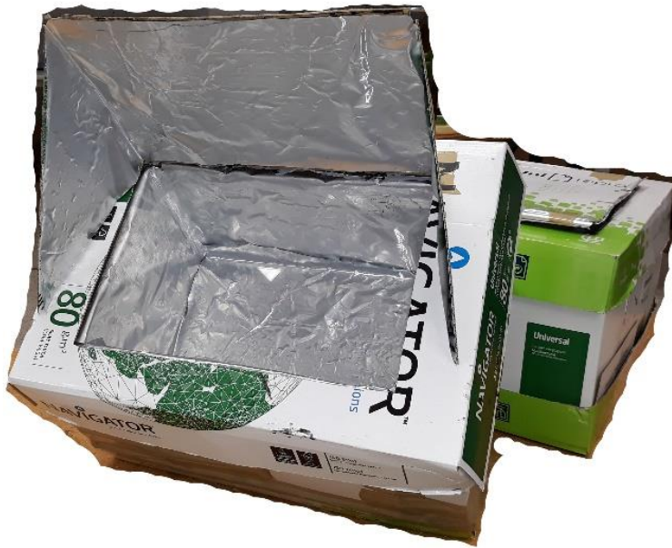
Ilustración 20. 2 hornos solares finalizados. Fuente: Koldo Bermejo.
