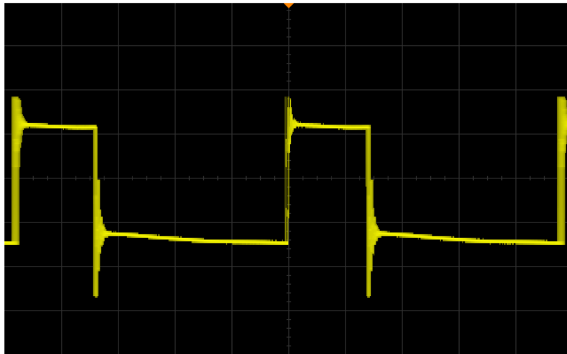
Figura 34: señal PWM con un ciclo de trabajo del 75%
