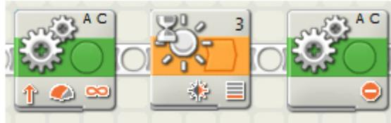
Para realizar este programa se necesita conectar un motor al puerto A, otro motor al puerto C y un sensor de luz al puerto 3. Además se necesita un cinta aislante negra para dibujar una línea.
