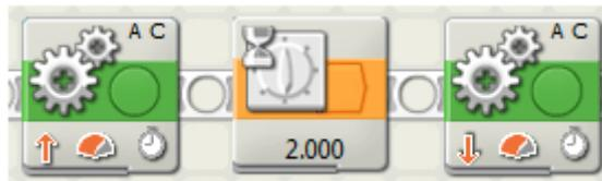
Para realizar este programa se necesita un robot NXT con dos motores, un motor conectado al puerto A y otro motor conectado al puerto C.
