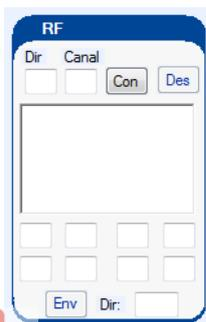
En la parte izquierda, incluye un módulo para la comunicación RF. Para utilizar este módulo es necesario conectar un módulo de RF en la llave RF-USB. Una vez introducida una dirección y un canal, se puede hacer clic en conectar, “Con” y se establecerá la comunicación. Se podrá recibir como enviar datos, en el cuadro de texto se verán los datos recibidos. Cuando se envíe un dato, el botón de enviar, “Env”,
