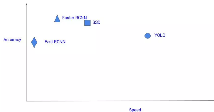
Ilustración 55 - Precisión respecto a velocidad para los distintos algoritmos de detección de objetos
