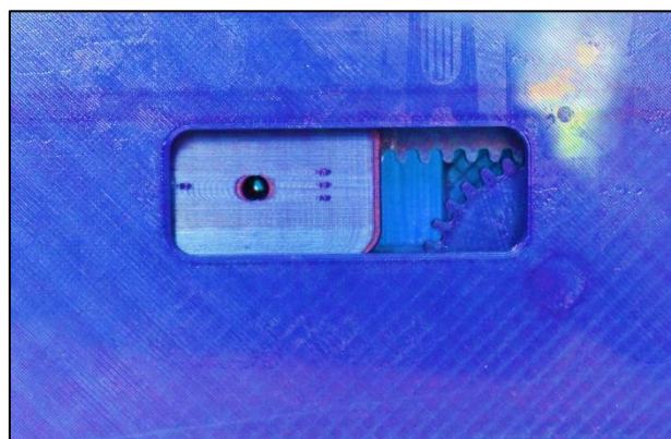
Figura 27. Detalle del sistema de apertura desde el exterior.
